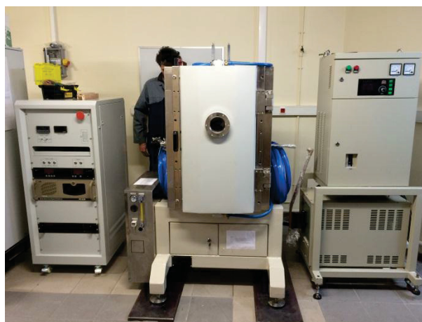
Figure 7.16 : Nouvelle machine de tirage Czochralski permettant la croissance de cristaux de 50mm de diamètre.
