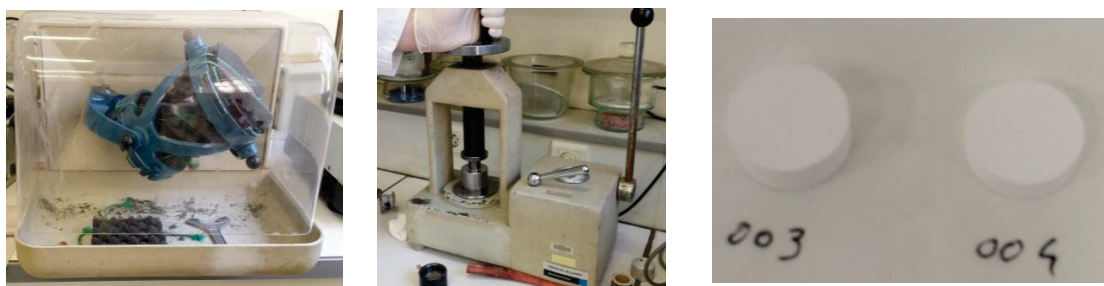
Figure 2.1 : Photos de l'agitateur mécanique (gauche), de la presse uniaxiale (milieu) et des pastilles de \text{BCBF} avant frittage (droite).
