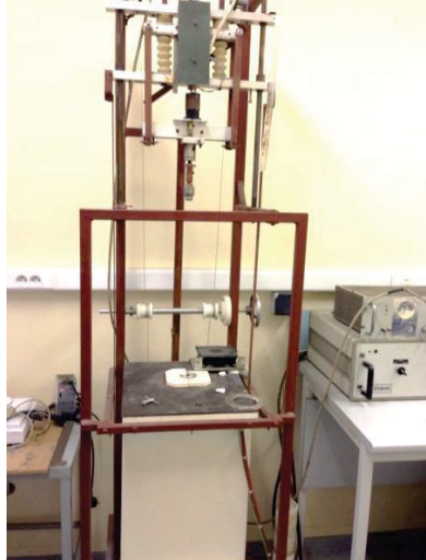
Figure 2.35 : Photo du four résistif utilisé pour l'essai de croissance par la méthode TSSG.
