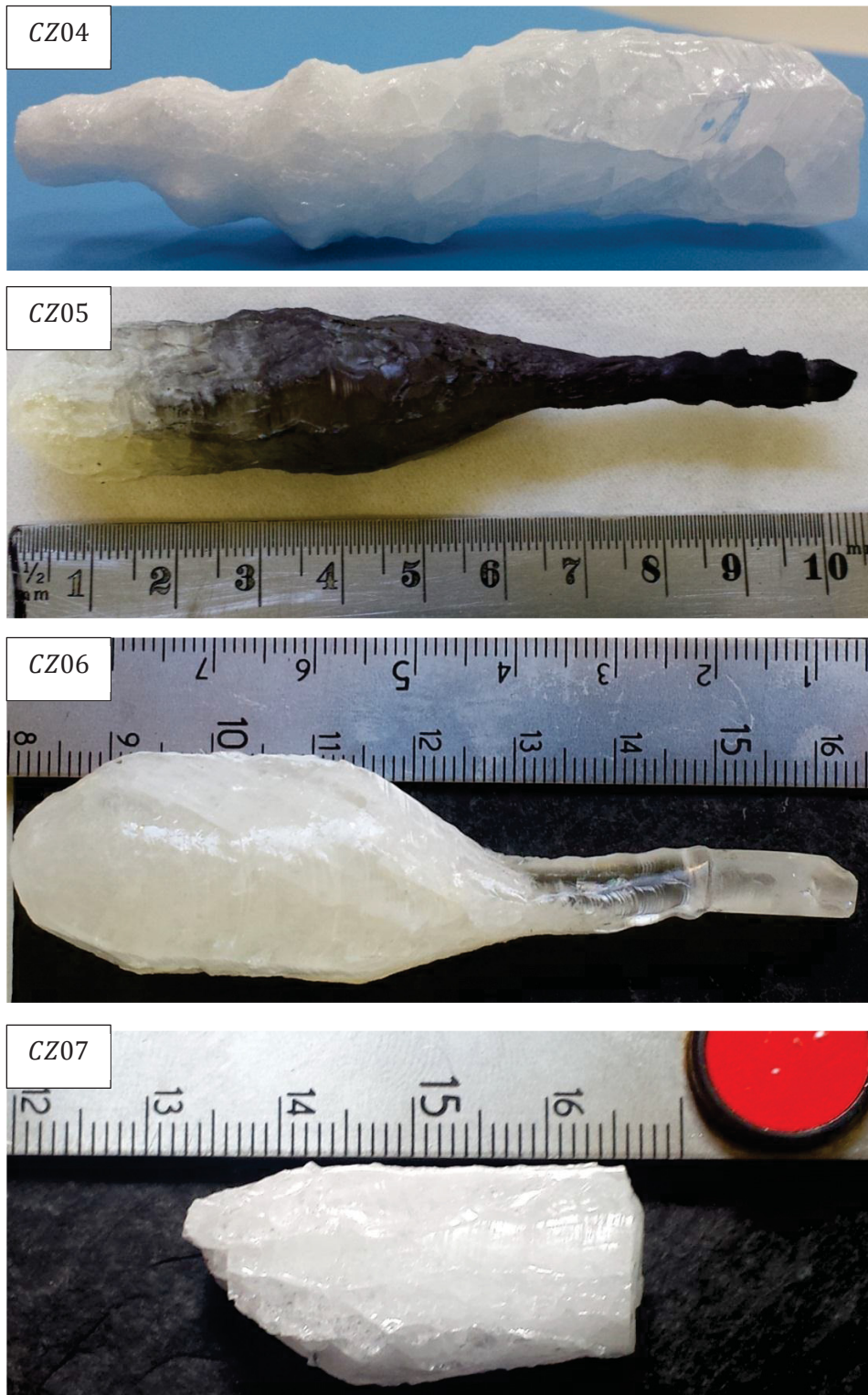
Figure 2.58 : Deuxième série de cristaux de LGSB:Yb obtenus par la méthode Czochralski à partir d'un flux (La, Gd)BO_3 .
