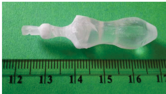
Figure 2.51 : Cristal de LGSB:Yb (13%) obtenu au SSQEL par la méthode Czochralski à partir du bain de composition (La_{0,54}Gd_{0,33}Yb_{0,13})_{1,25}Sc_{2,75}(BO_3)_4 . La direction de croissance se fait selon l'axe \vec{c} (orientation du germe).
