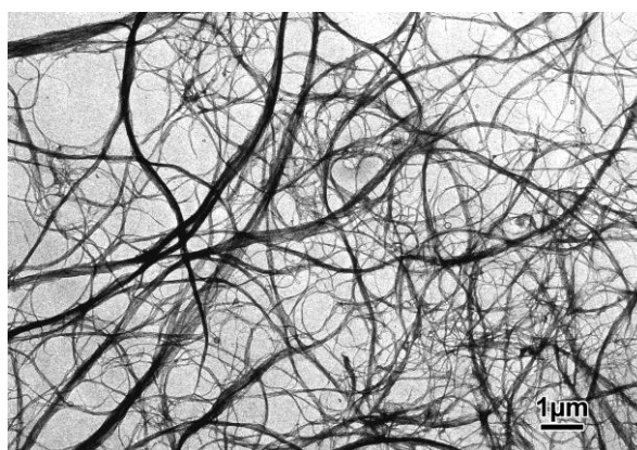
Figure I-14 : Microfibrilles extraites de la betterave homogénéisées au Manton Gaulin (H. Chanzy)
