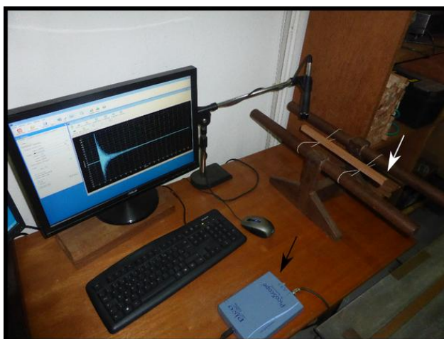
Figure 15 : Mesure du Module d'élasticité par la méthode BING. L'échantillon à tester est posée sur deux élastiques accrochés à un portoir. La sollicitation est appliquée à une extrémité et perpendiculairement à l'axe de l'échantillon (flèche blanche). Le signal analogique est enregistré par le microphone puis transformé en signal numérique par l'oscilloscope (flèche noire).
