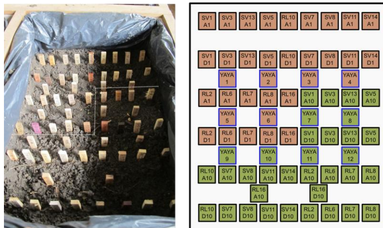
Figure 41 : Disposition des éprouvettes dans le bac.
