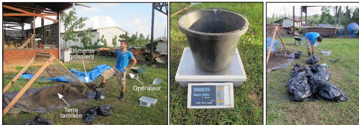
Figure 40 : Préparation de la terre des essais de durabilité.
