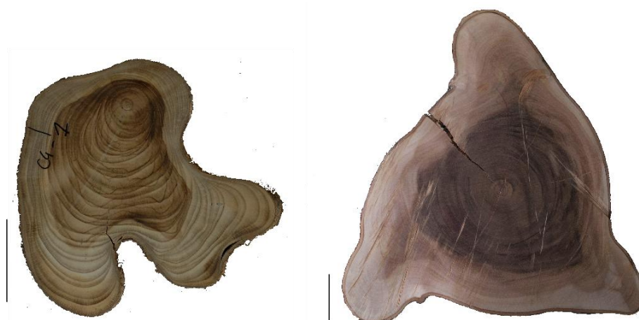
Figure 7 : L'excentricité du duramen suit l'excentricité de la section.
