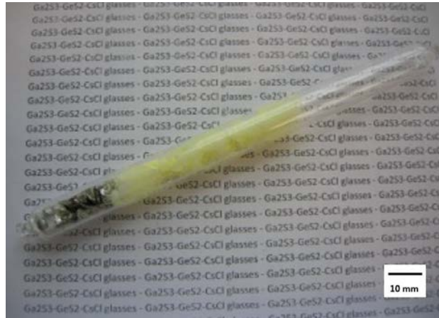
Figure 2.7 : Tube de silice scellé contenant les réactifs
