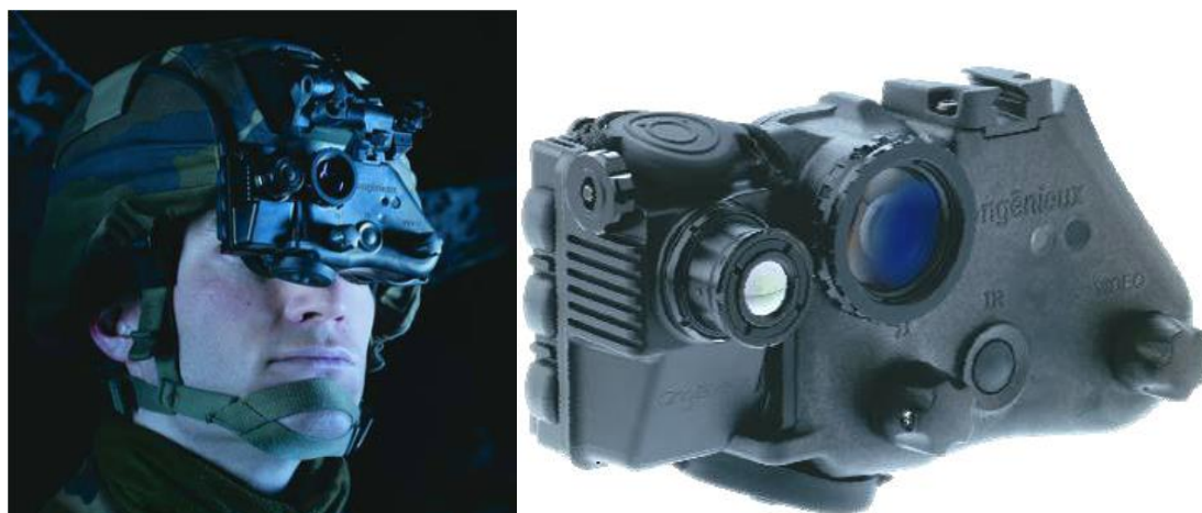
Figure 1.7: Exemple de lunette de vision nocturne à fusion de senseurs mise sur le marché en 2010 par Thales Angénieux (Intensification Lumière + Infrarouge) [12]
