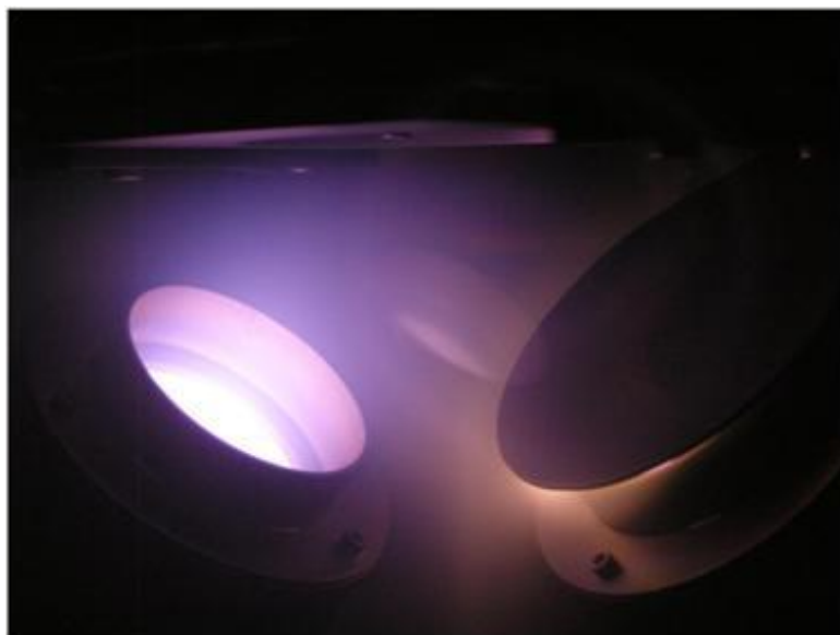
Figure 4.7 : Plasma froid formé lors du dépôt par pulvérisation cathodique
