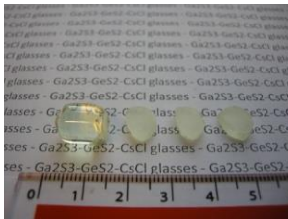
Figure 2.8 : Barreau de verre et pastilles découpées à la scie à fil
