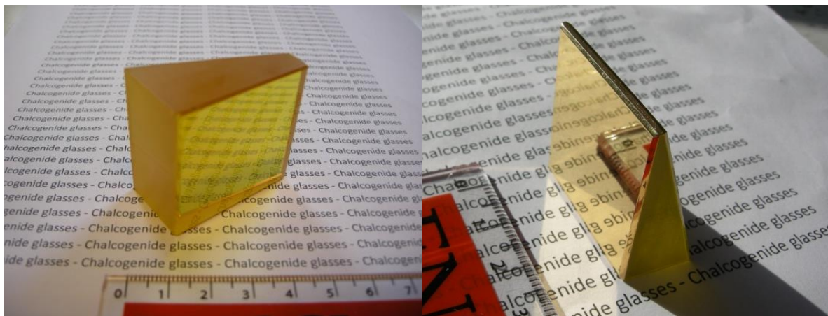
Figure 3.19 : Prismes utilisés pour la mesure par la méthode Littrow (gauche 75\text{GeS}_2-15\text{Ga}_2\text{S}_3-10\text{CsCl} sans dépôt d'or et droite 65\text{GeS}_2-20\text{Ga}_2\text{S}_3-15\text{CsCl} avec dépôt d'or)
