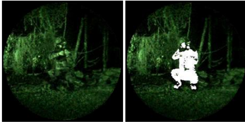
Figure 1.8: Différence entre une image avec intensification de lumière (à gauche) et une image avec intensification de lumière fusionnée avec une image infrarouge (à droite) [12]
