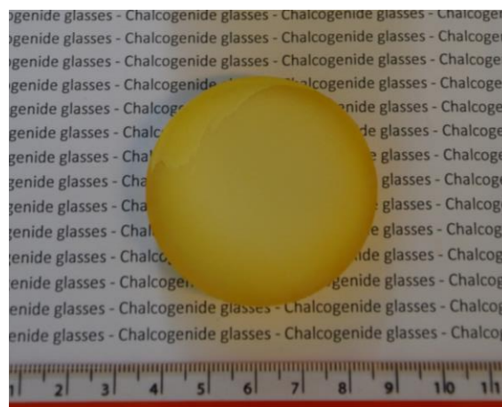
Figure 3.5 : Synthèse du verre 70,5\text{GeS}_2-14,5\text{Ga}_2\text{S}_3-15\text{CsCl} en diamètre 50mm
