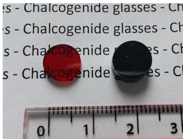
Figure 2.14 : Comparaison entre un verre avec CsI (0,6 GeSe_2-0,4Ga_2Se_3)_{70}CsI_{30} et un verre sans CsI (0,8 GeSe_2-0,2Ga_2Se_3)
