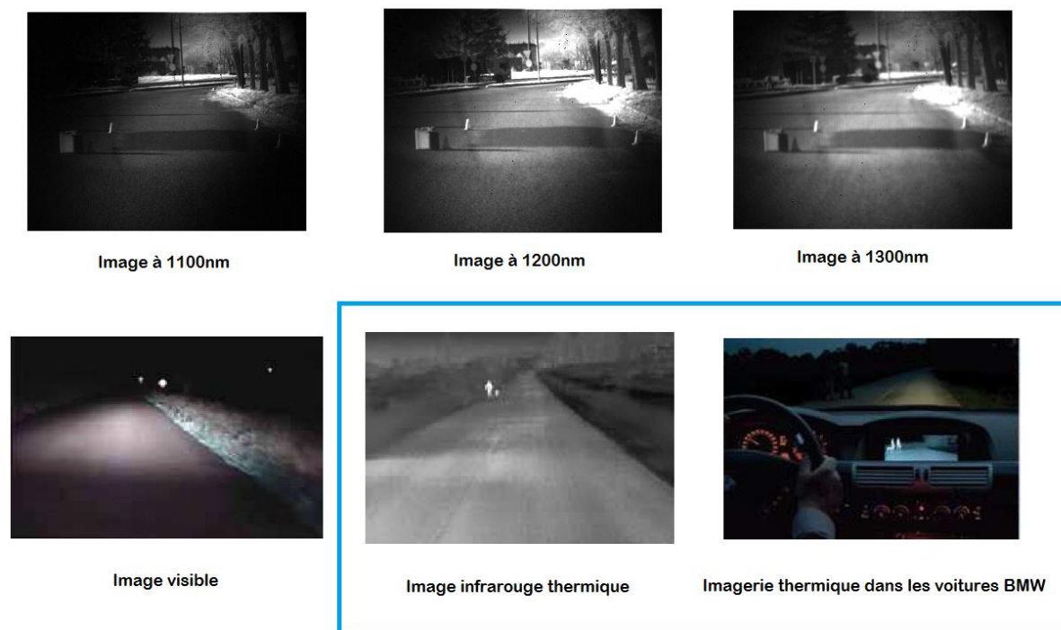
Figure 1.10: En haut, images dans la bande SWIR permettant de détecter la présence de verglas. En bas, l'imagerie thermique permettant de détecter la présence de piétons déjà présente dans les voitures BMW
