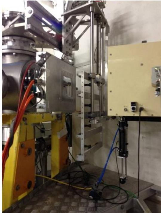
**Figure 22: Photo du porteur d'échantillon robotisé en position d'origine (ligne IRABAT)**
