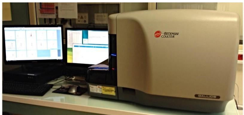
**Figure 27: Cytomètre en flux GALLIOS (BIOTICLA, Caen)**
