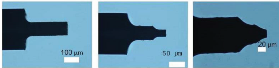
Figure 28 – Amincissement d'une électrode-outil de 300 \mu\text{m} à 25 \mu\text{m} de diamètre par WEDG d'après [99].
