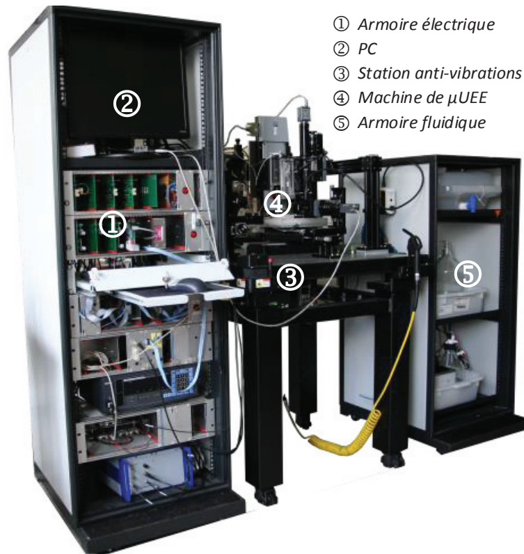
Figure 49 – Vue de la machine de 2 ème génération avec les postes gravure et usinage sur la table anti vibration et les armoires électronique (à gauche) et fluidique (à droite).
