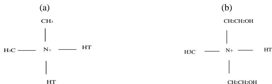
Figure 16: (a) Organomodifiant de la Cloisite ® 20A ; (b) Organomodifiant de la Cloisite ® 30B ; HT représente une chaîne hydrocarbonée, sa composition en pourcentage massique des chaînes hydrocarbonées (Tallow) est de: 65 % de C18, 30 % de C16 et 5 % de C14
