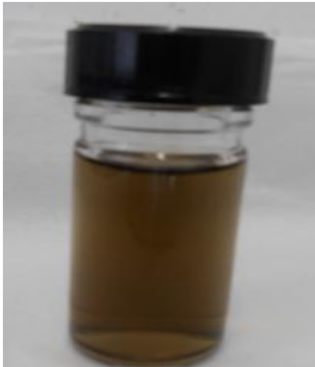
Figure 49 : Suspension d'oxyde de graphène dans l'eau
