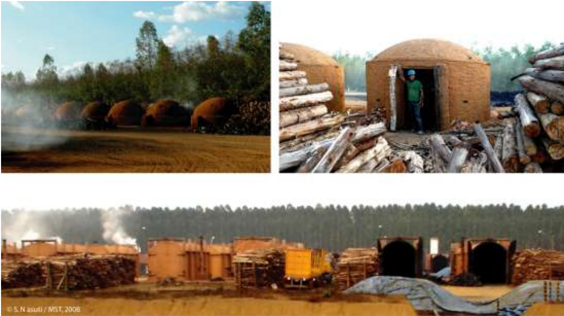
Photo 27 : Types de fours utilisés dans la fabrication du charbon de bois
