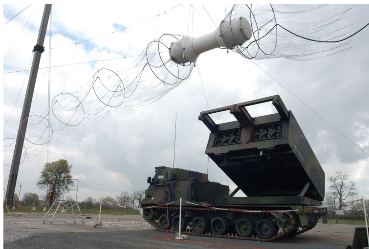
FIGURE 2.3 – Générateur capable de reproduire l'IEMN à échelle réelle sur des systèmes.
