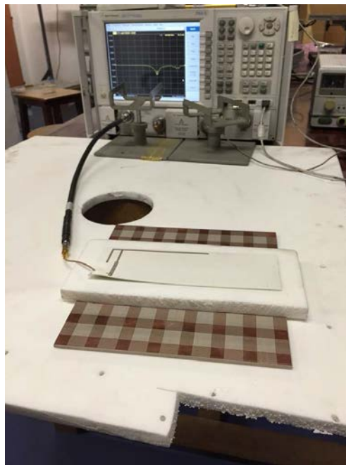
FIGURE A.6 – Mesure du coefficient de réflexion du CMA à capacité interdigité sur AD1000 – IFA souple.
