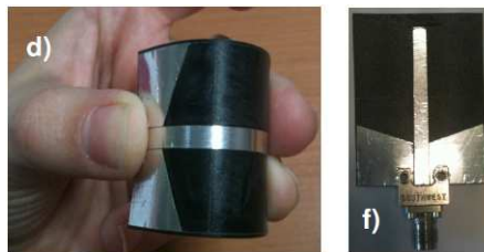
FIGURE 1.36 – Monopole sur une feuille de polypropylène [89].
