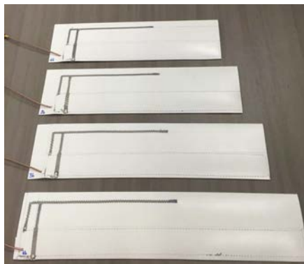
FIGURE 4.44 – Quatre antennes IFA avec \tau = -20, -10, +10 et +20 mm.
