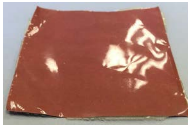
FIGURE 2.3 – Matériau PS avec plan de masse intégré.
