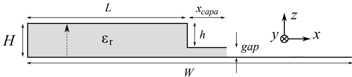
FIGURE 4.6 – Vue en coupe de l'antenne PIFA.
