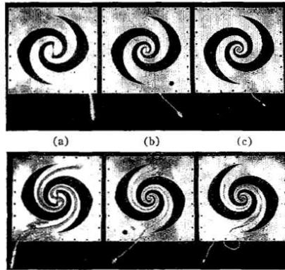
FIGURE 1.2 – Trois antennes spirales logarithmiques [6].
