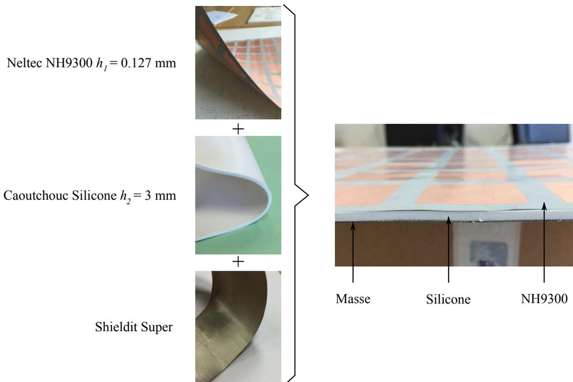
FIGURE 5.55 – assemblage CMA 400MHz double couche.
