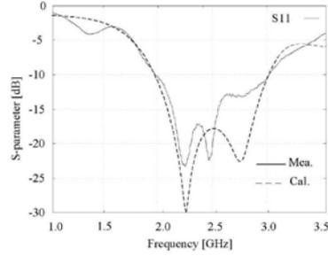
FIGURE 1.22 – Coefficient de réflexion du monopole [50].
