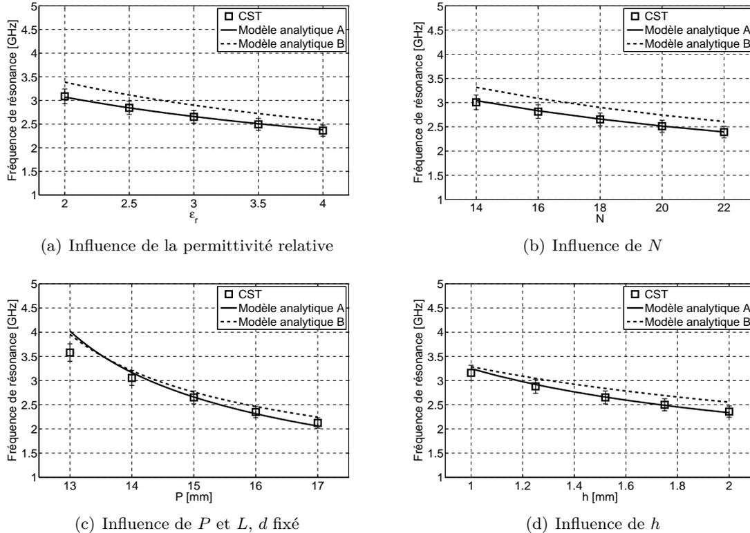
FIGURE 5.26 – Comparaison des fréquences de résonance obtenues en simulation avec celles issues des modèles analytiques pour les paramètres  $N$ ,  $L$ ,  $h$  et la permittivité relative. La barre d'erreur représente  $\pm 5\%$ .
