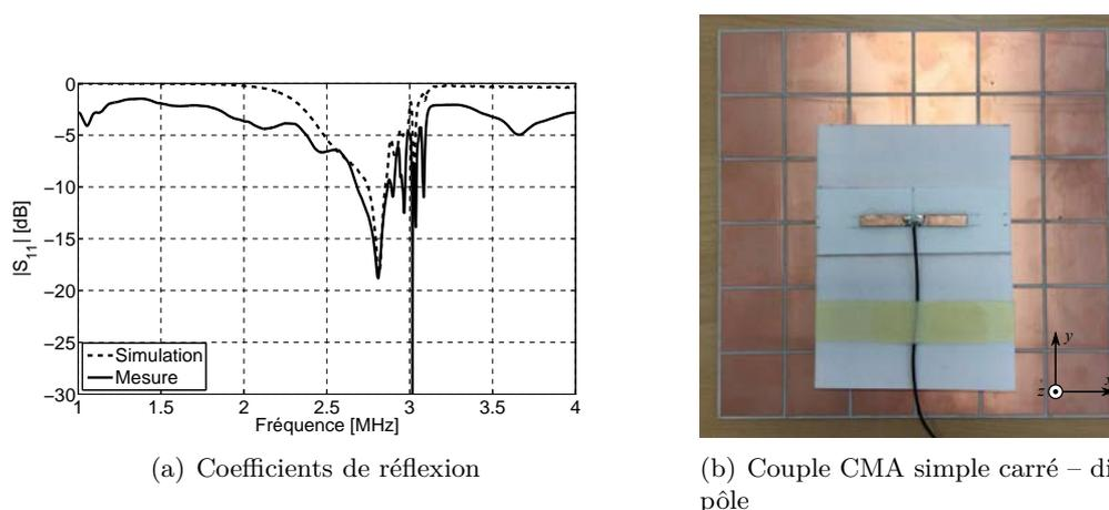
FIGURE 6.1 – Mesure du coefficient de réflexion du couple CMA simple carré - dipôle.
