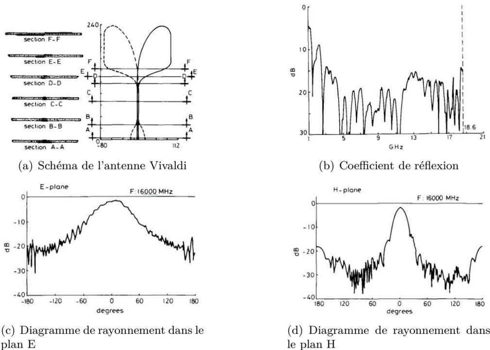
FIGURE 1.5 – Première antenne Vivaldi antipodale proposée [16].
