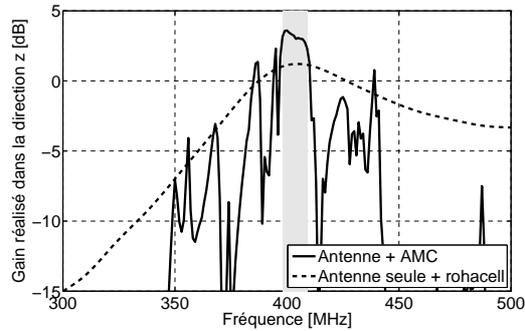
(b) Gain réalisé dans la direction z
