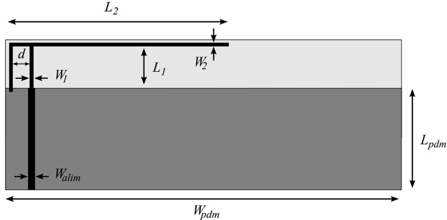
FIGURE 4.12 – Géométrie de référence de l'antenne IFA.
