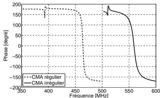
FIGURE A.2 – Phase du coefficient de réflexion du CMA irrégulier  $4 \times 4$  cellules comparée à sa version régulière.
