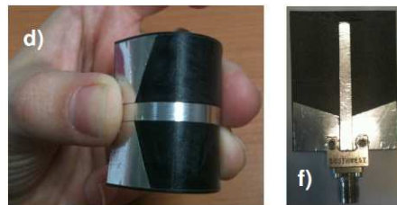
FIGURE 1.36 – Monopole sur une feuille de polypropylène [89].
