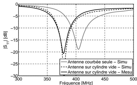
FIGURE 4.42 – Coefficient de réflexion de l'antenne courbée seule et sur le cylindre de PVC vide.
