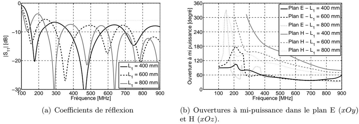
FIGURE 3.4 – Etude paramétrique sur  $L_1$  avec  $H = 600$  mm.
