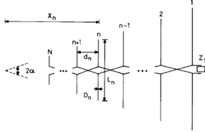
FIGURE 1.6 – Schéma de principe d'une antenne log-périodique [18].
