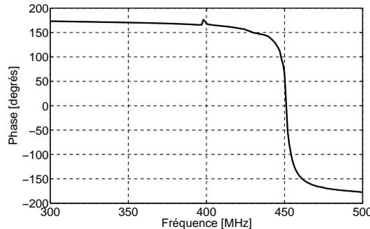
FIGURE C.2 – Phase du coefficient de réflexion simulée pour le CMA double couche sur Neltec NY9255  $7 \times 7$  cellules.
