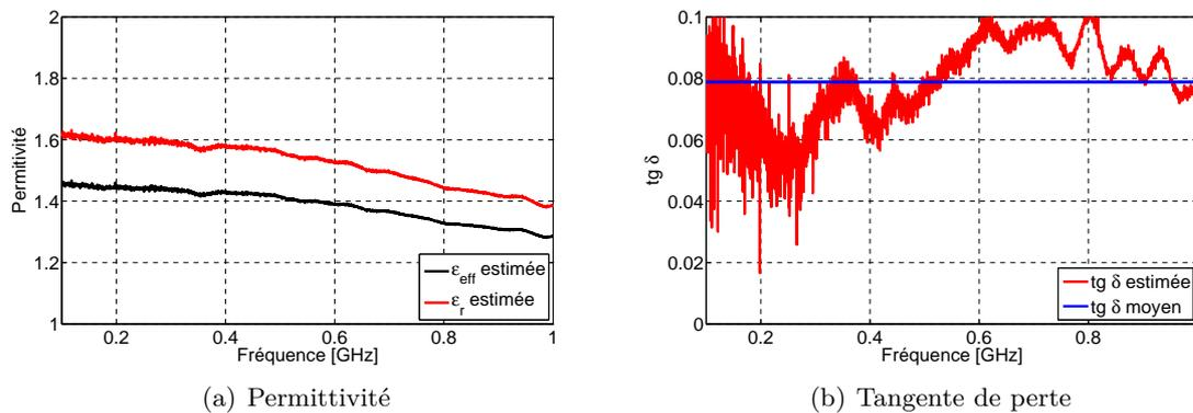
FIGURE 2.19 – Estimation des caractéristiques diélectriques de la feutrine.
