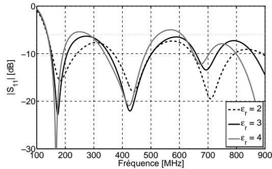
FIGURE 3.8 – Influence de la permittivité sur le coefficient de réflexion (normalisé  $50\Omega$ ).
