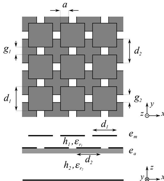
FIGURE 5.42 – Schéma du CMA double couche proposé.
