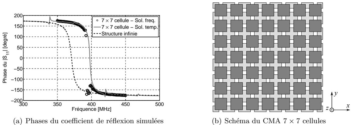
FIGURE 5.53 – Phases du coefficient de réflexion simulées pour une structure finie  $7 \times 7$  cellules et infinie.
