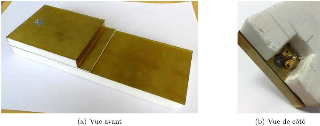
FIGURE 4.8 – Photographie de l'antenne PIFA avec capacité réalisée.
