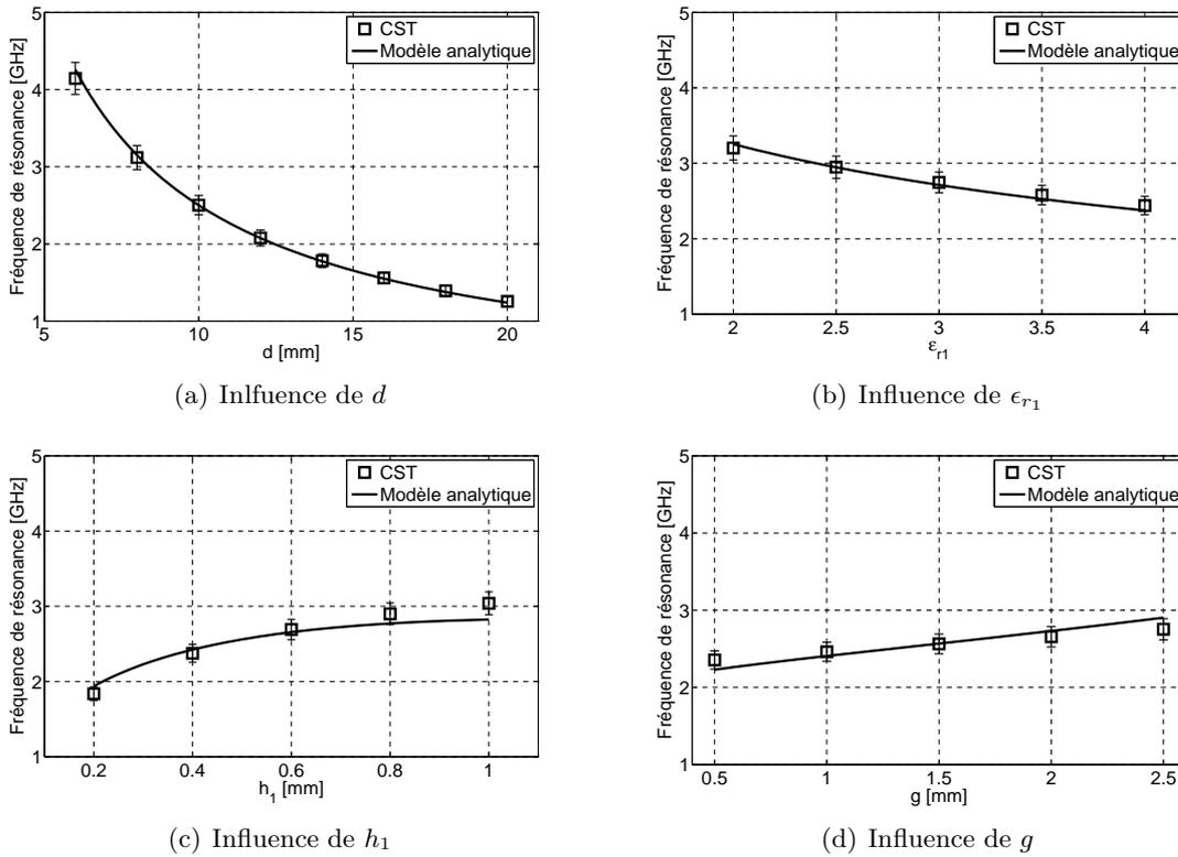
FIGURE 5.47 – Comparaison de l'estimation de la fréquence de résonance entre simulation et modèle analytique pour les paramètres  $d$ ,  $\epsilon_{r1}$ ,  $g$  et  $h_1$ . La barre d'erreur représente  $\pm 5\%$ .
