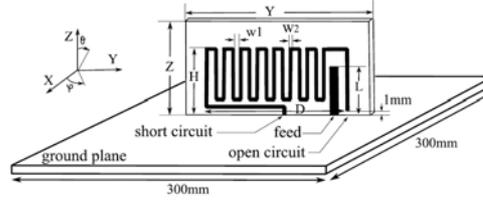
FIGURE 1.26 – Antenne boucle court-circuitée alimentée par couplage par un petit monopole,  $Y = 50$  mm et  $Z = 25$  mm [60].
