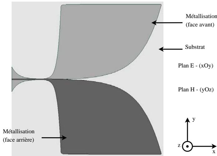
FIGURE 3.2 – Schéma de l'antenne Vivaldi antipodale proposée.
