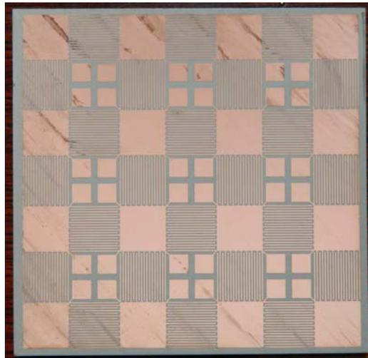
FIGURE 5.31 – CMA à capacités interdigitées avec pavés sur Neltec NH9410.
