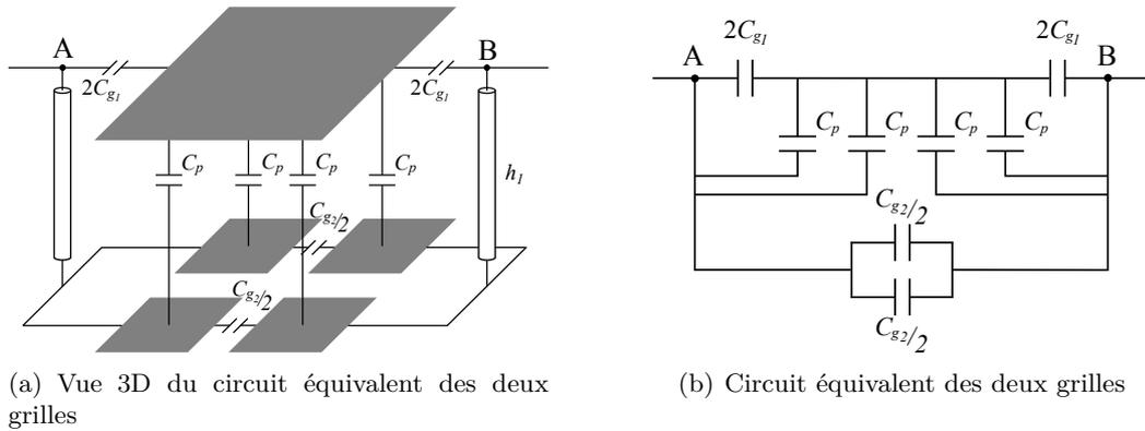
FIGURE 5.44 – Circuits équivalents des deux grilles.
