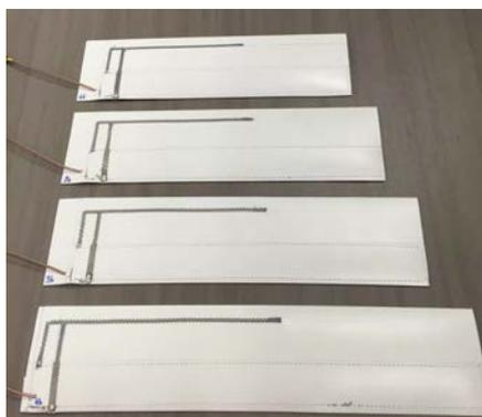
FIGURE 4.44 – Quatre antennes IFA avec  $\tau = -20, -10, +10$  et  $+20$  mm.
