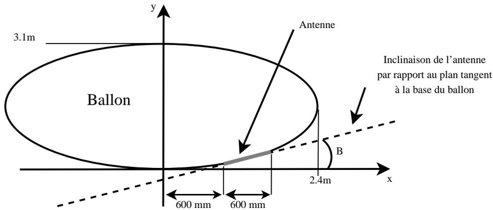
FIGURE 3.25 – Position de l'antenne sous le ballon.
