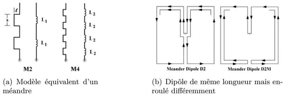
FIGURE 1.18 – Illustration des méandres et de l'enroulement [42].
