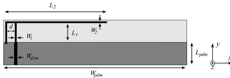
FIGURE 4.29 – Géométrie de l’antenne IFA avec petit plan de masse.
