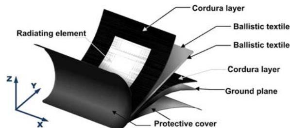
FIGURE 1.34 – Antenne Iridium/GPS pour environnement hostile [74].
