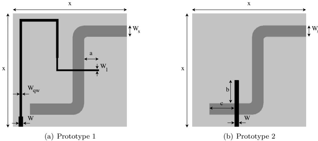
FIGURE 4.2 – Antennes fentes. (a) Alimentation par transformateur quart d'onde. (b) Alimentation par ligne microruban  $50\Omega$ .  $W = 3.7$  mm,  $W_l = 1$  mm,  $W_s = 10$  mm,  $W_{qw} = 2.1$  mm,  $a = 13$  mm,  $b = 20.4$  mm and  $c = 22.2$  mm.
