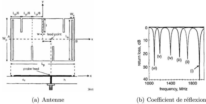
FIGURE 1.9 – (a) Antenne patch avec des fentes,  $W_p = 24$  mm,  $L_p = 36$  mm,  $h = 1.6$  mm,  $\epsilon_r = 4.4$  mm. (b) Coefficients de réflexion en fonction de la longueur de la fente : (i) aucune fente, (vi)  $l = 13$  mm [28].
