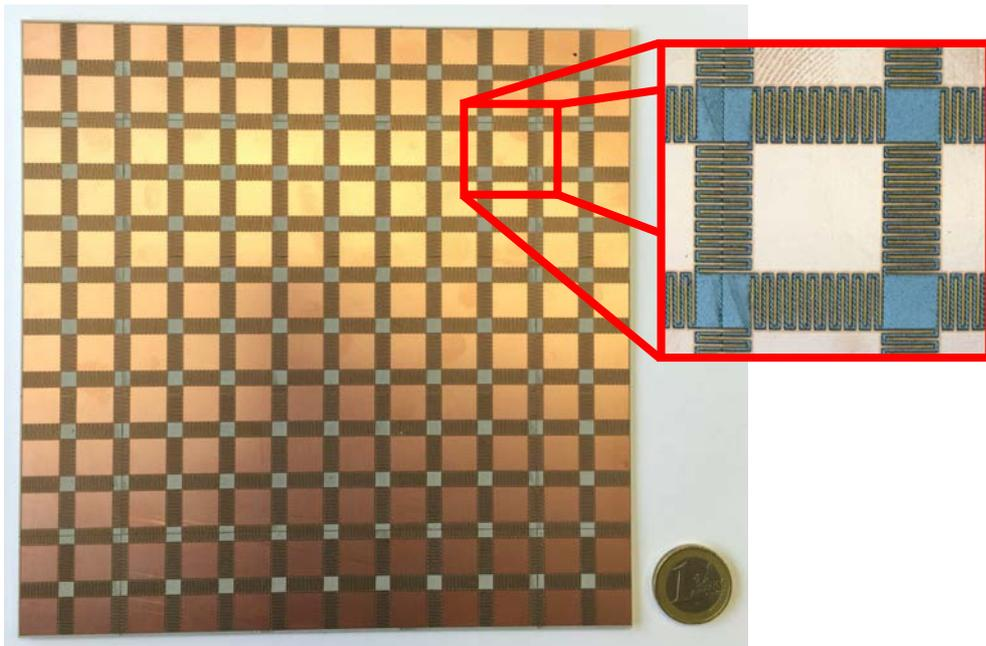
FIGURE 5.27 – CMA à capacités interdigitées  $12 \times 12$  cellules.
