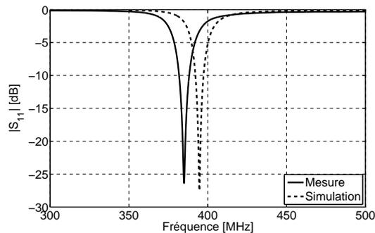
FIGURE 4.9 – Coefficient de réflexion simulé et mesuré de l'antenne PIFA avec capacité.
