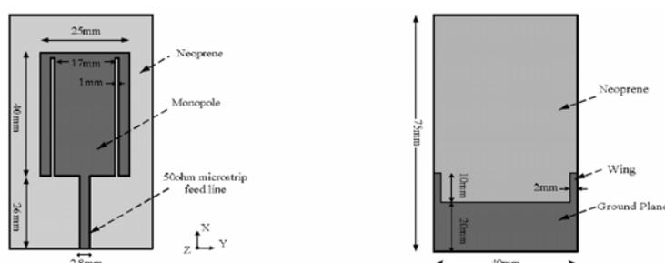
FIGURE 1.20 – Monopole pour les bandes GSM 900 et UMTS/WLAN [49].
