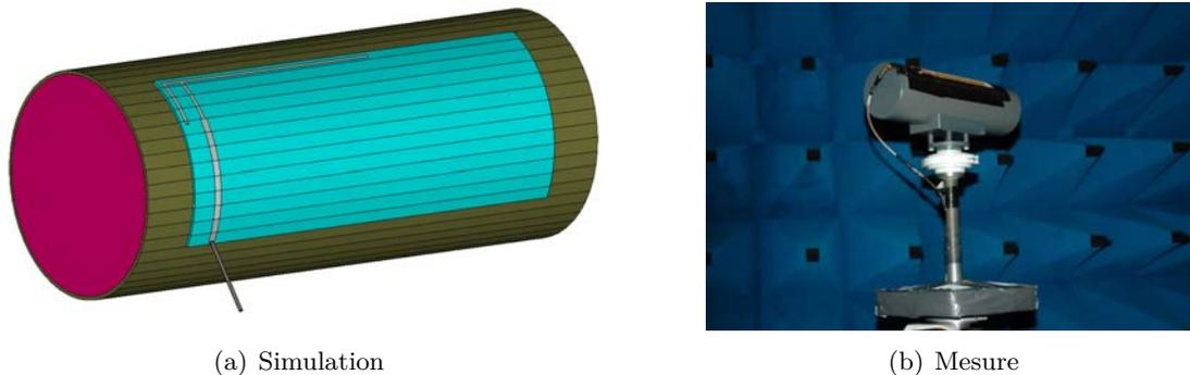
FIGURE 4.41 – Antenne IFA courbée sur un cylindre PVC.
