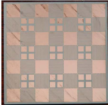
FIGURE A.1 – CMA irrégulier à capacités interdigitées avec pavés sur Neltec NH9410.
