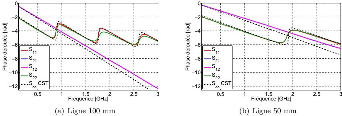
FIGURE 2.15 – Phases des paramètres S mesurés et simulés.
