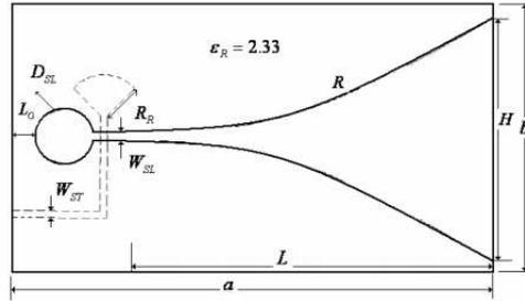
FIGURE 1.4 – Schéma d’une antenne Vivaldi [14].
