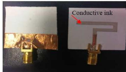
(b) Une antenne réalisée par flexographie
