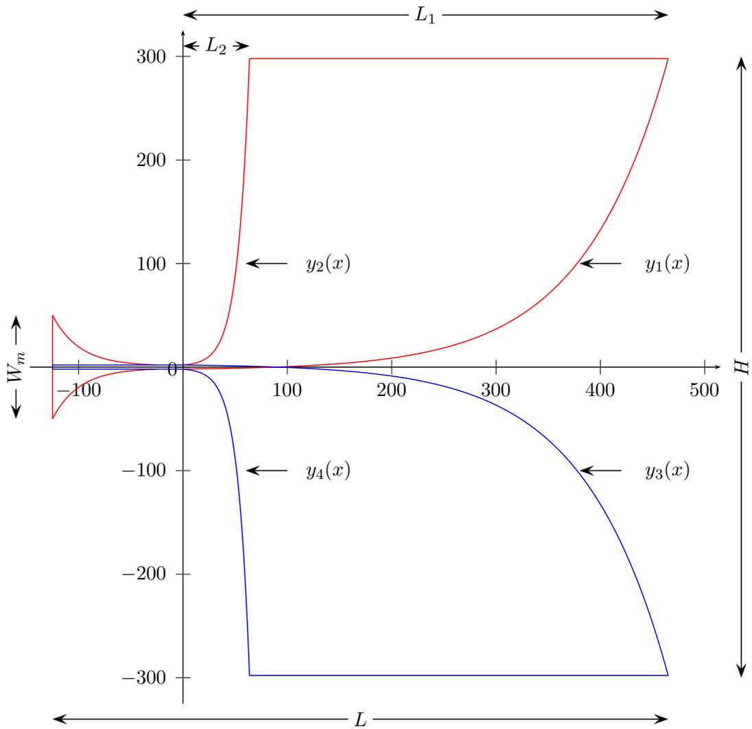
FIGURE 3.3 – Géométrie à l'échelle de l'antenne Vivaldi [mm].
