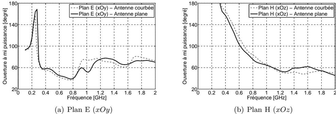
FIGURE 3.20 – Ouverture à mi-puissance simulée pour les plans E et H.
