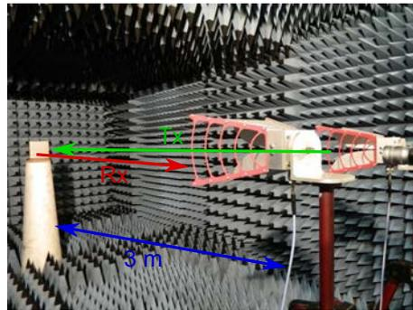
FIGURE 5.17 – Configuration de mesure en réflexion d'un CMA.
