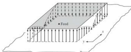
FIGURE 1.12 – Distribution du champ électrique sous un patch [35].
