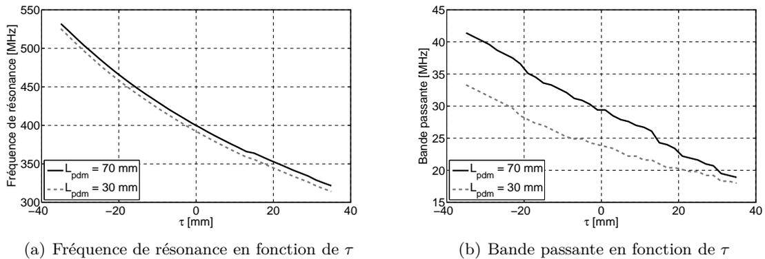
FIGURE 4.24 – Influence du paramètre  $\tau$  sur la fréquence de résonance et la bande passante de l'antenne pour deux configurations de plan de masse :  $L_{pdm} = 30$  mm et  $L_{pdm} = 70$  mm.
