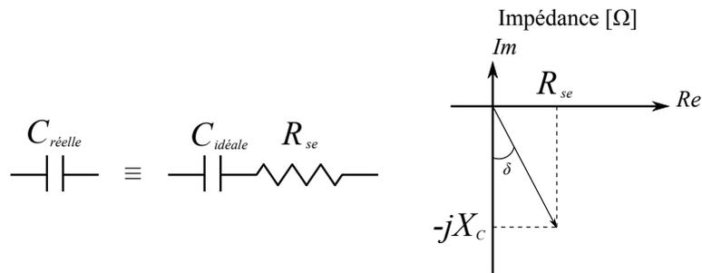
FIGURE 5.33 – Modèle équivalent d'une capacité réelle.
