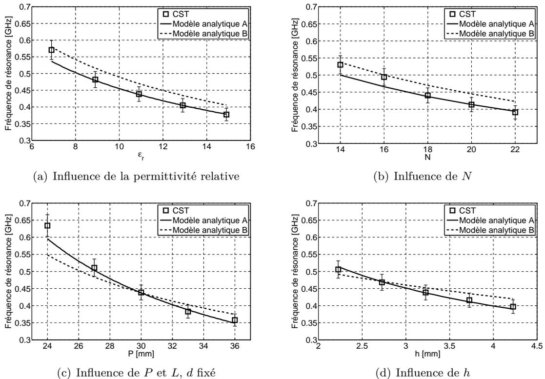
FIGURE 5.36 – Comparaison des fréquences de résonance obtenues en simulation avec celles issues des modèles analytiques pour les paramètres  $N$ ,  $L$ ,  $h$  et la permittivité relative. La barre d'erreur représente  $\pm 5\%$ .
