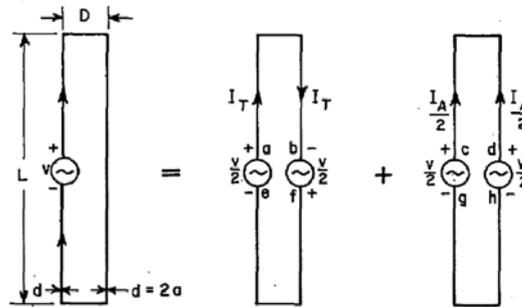
FIGURE 1.27 – Décomposition du dipôle replié dans le mode ligne de transmission et le mode antenne [61].
