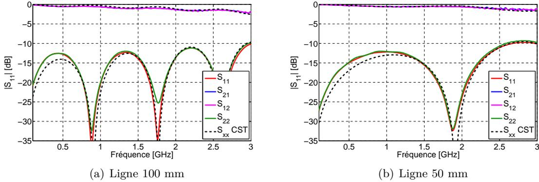
FIGURE 2.14 – Modules des paramètres S mesurés et simulés.
