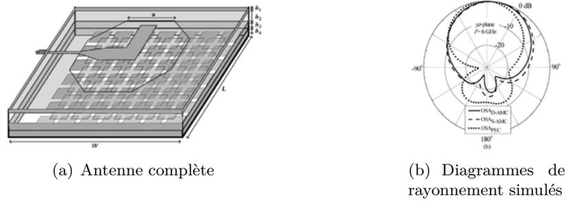
FIGURE 5.13 – Antenne associée avec un CMA double couche [137].
