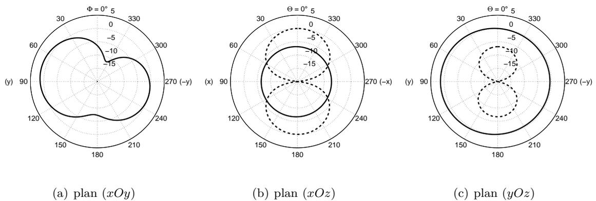
FIGURE 4.27 – Diagrammes de rayonnement simulés de l'antenne IFA
