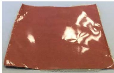
FIGURE 2.3 – Matériau PS avec plan de masse intégré.
