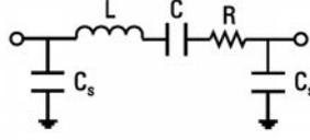
FIGURE 5.24 – Schéma équivalent d'une capacité interdigitée [143].
