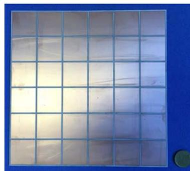
FIGURE 5.15 – CMA  $6 \times 6$  cellules réalisé.
