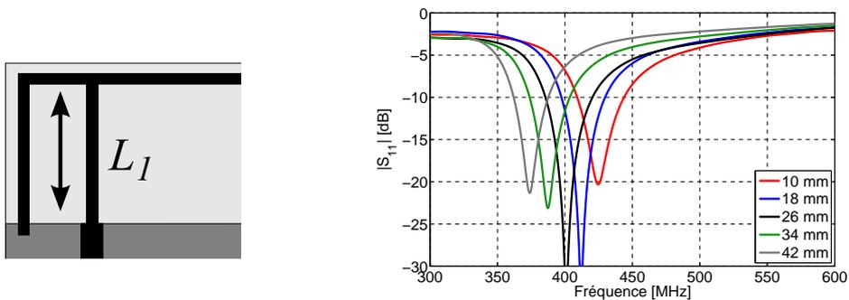
FIGURE 4.15 – Influence de  $L_1$  sur le coefficient de réflexion.
