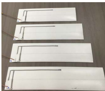
FIGURE 4.44 – Quatre antennes IFA avec \tau = -20, -10, +10 et +20 mm.
