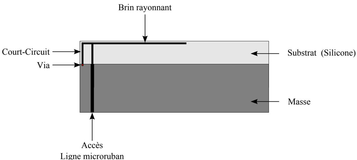
FIGURE 4.11 – Schéma de l'antenne IFA proposée.
