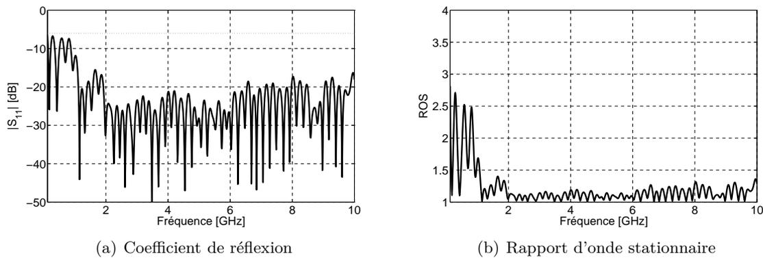
FIGURE 3.9 – Adaptation de l'antenne sur une très large bande (simulation).
