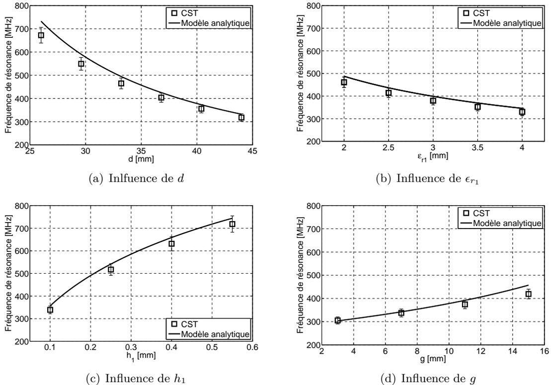
FIGURE 5.51 – Comparaison de l'estimation de la fréquence de résonance entre simulation et modèle analytique pour les paramètres  $d$ ,  $\epsilon_{r1}$ ,  $g$  et  $h_1$ . La barre d'erreur représente  $\pm 5\%$ .
