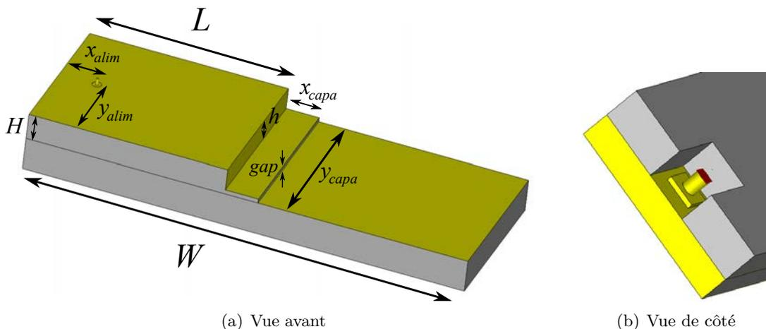
FIGURE 4.7 – Modélisation CST de l'antenne PIFA avec capacité.
