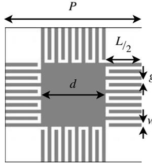
FIGURE 5.22 – Schéma de la cellule unitaire avec capacités interdigitées.
