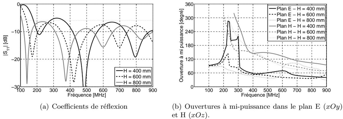
FIGURE 3.5 – Etude paramétrique sur  $H$  avec  $L_1 = 600$  mm.
