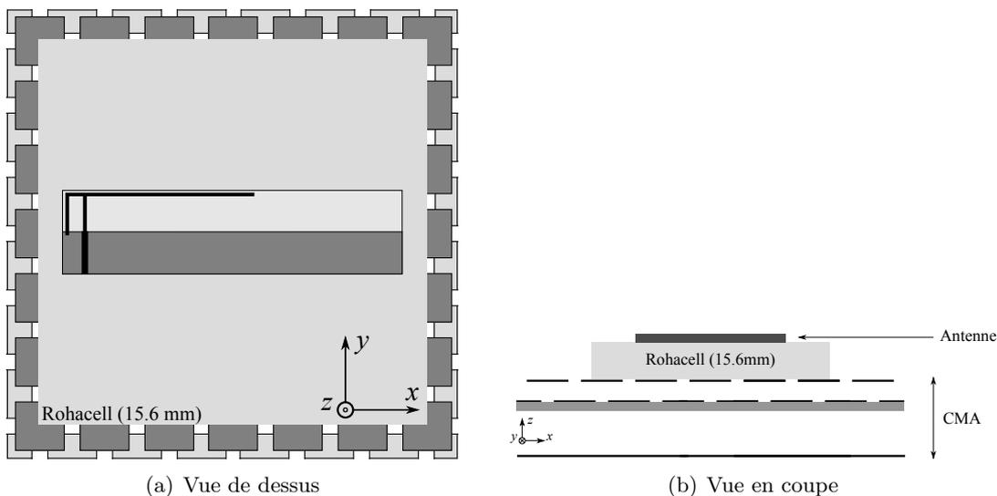
FIGURE 6.15 – CMA double couche associé à l'antenne IFA.
