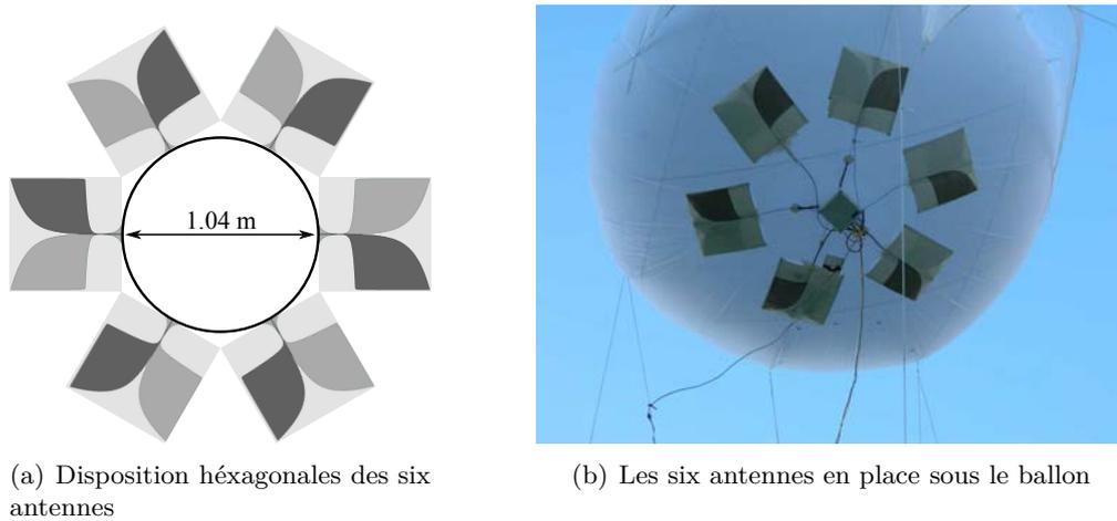
FIGURE 3.24 – Implantation des antennes sur le ballon.
