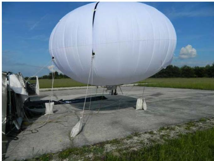
FIGURE 3.23 – Ballon gonflé à l’hélium maintenu par des lests.
