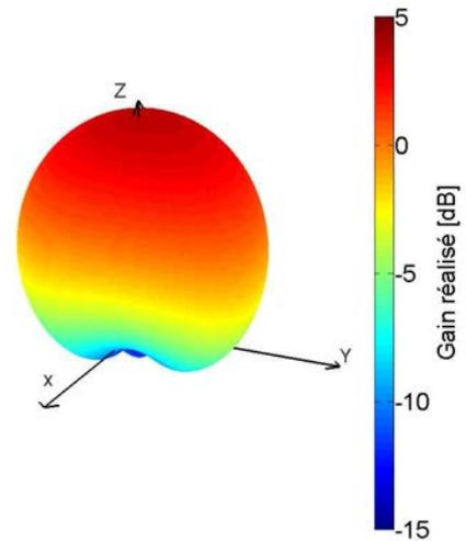
FIGURE 6.17 – Gain réalisé 3D pour  $f = 401$  MHz.
