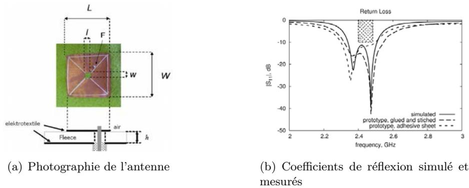
FIGURE 1.35 – Antenne patch sur textile polaire [83].
