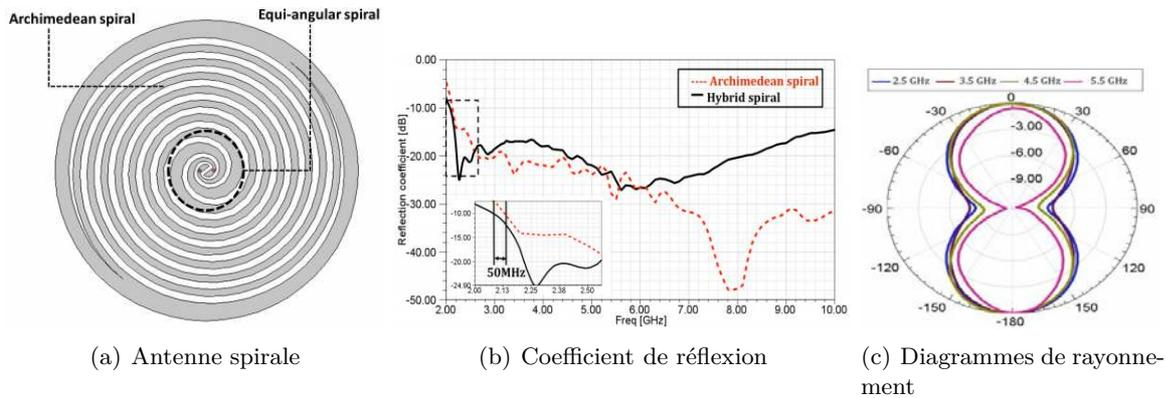
FIGURE 1.3 – Représentation d’une antenne spirale avec son coefficient de réflexion et ses diagrammes de rayonnement [7].
