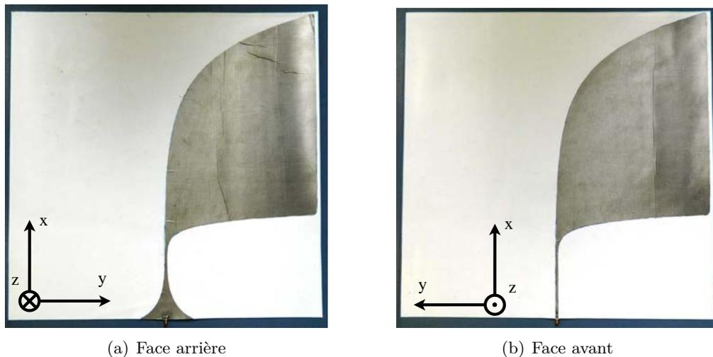
FIGURE 3.14 – Vues du prototype de l'antenne Vivaldi.
