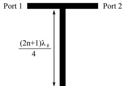
FIGURE 2.4 – Schéma d'un stub ouvert résonant quart d'onde.
