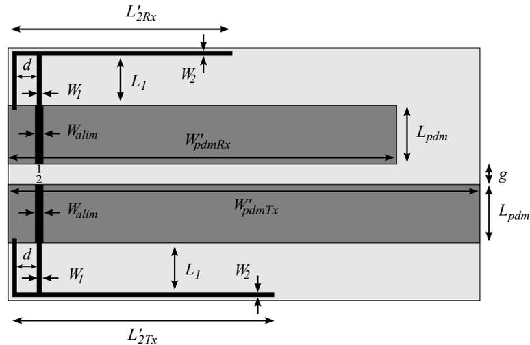
FIGURE 4.47 – Schéma de l'antenne half-duplex avec plan de masse séparé.
