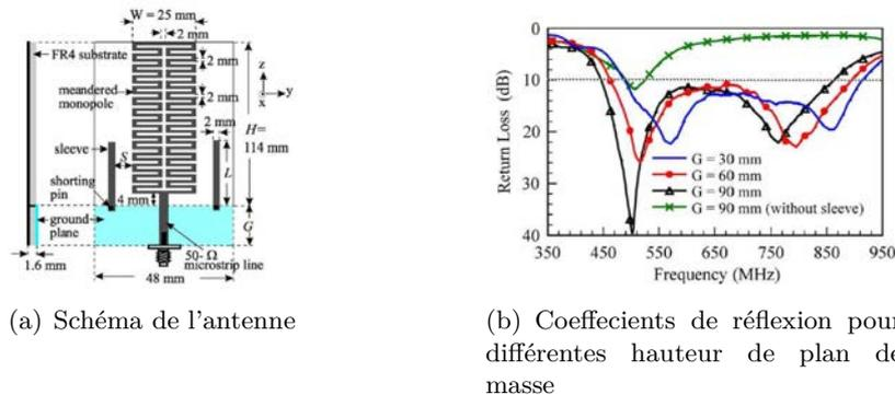
FIGURE 1.19 – Antenne monopole à méandre [44].
