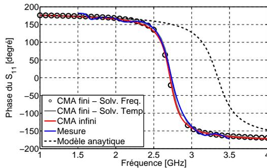
FIGURE 5.18 – Phases du coefficient de réflexion.
