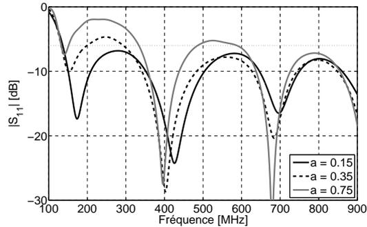
FIGURE 3.6 – Influence du coefficient  $a$  sur le bas de la bande passante.
