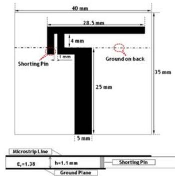
FIGURE 1.16 – Dimensions de l'antenne IFA imprimée [39]
