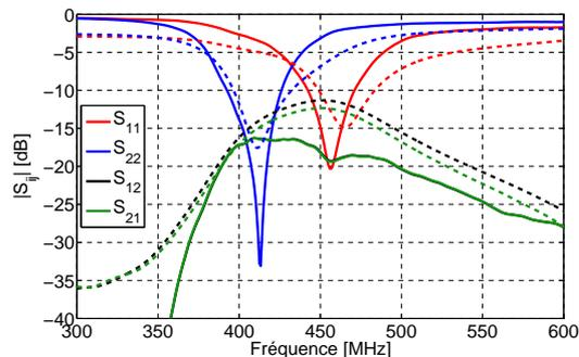
FIGURE 4.52 – Coefficients de réflexion et transmission de l'antenne bi-fréquence avec plan de masse unique (—) Mesure (- - -) Simulation.
