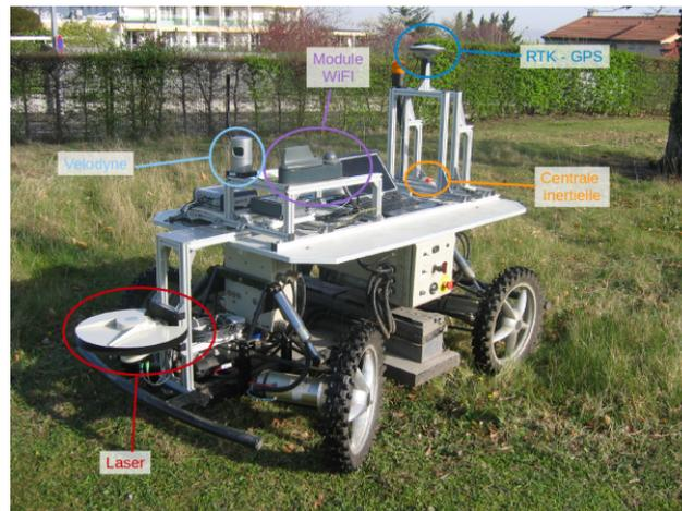
FIGURE A.8 – Capteurs embarqués (exemple sur RobuFAST)
