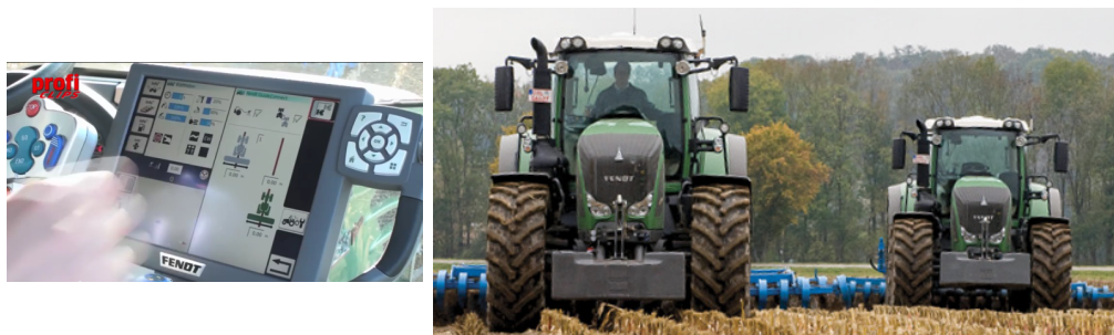
FIGURE 1.10 – Solution GuideConnect de Fendt, gestion déportée d'un tracteur suiveur
