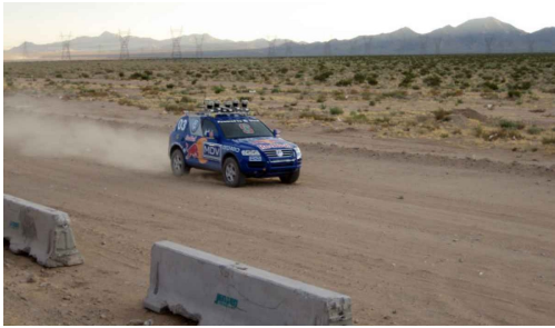
(a) DARPA Grand Challenge (2005) : Navigation autonome dans le désert par le robot vainqueur Stanley
