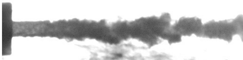
FIGURE VI.6 – Image obtenue par rétroéclairage avec une source lumineuse HMI sans filtre mettant en évidence le jet dense d’oxygène [GBV01b].
