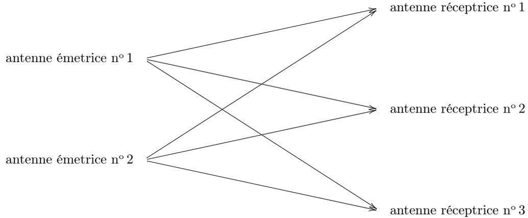
FIGURE 1.6 – Transmission MIMO. Chaque antenne émettrice est reliée à chaque antenne réceptrice par une transmission SISO (voir figure 1.5).
