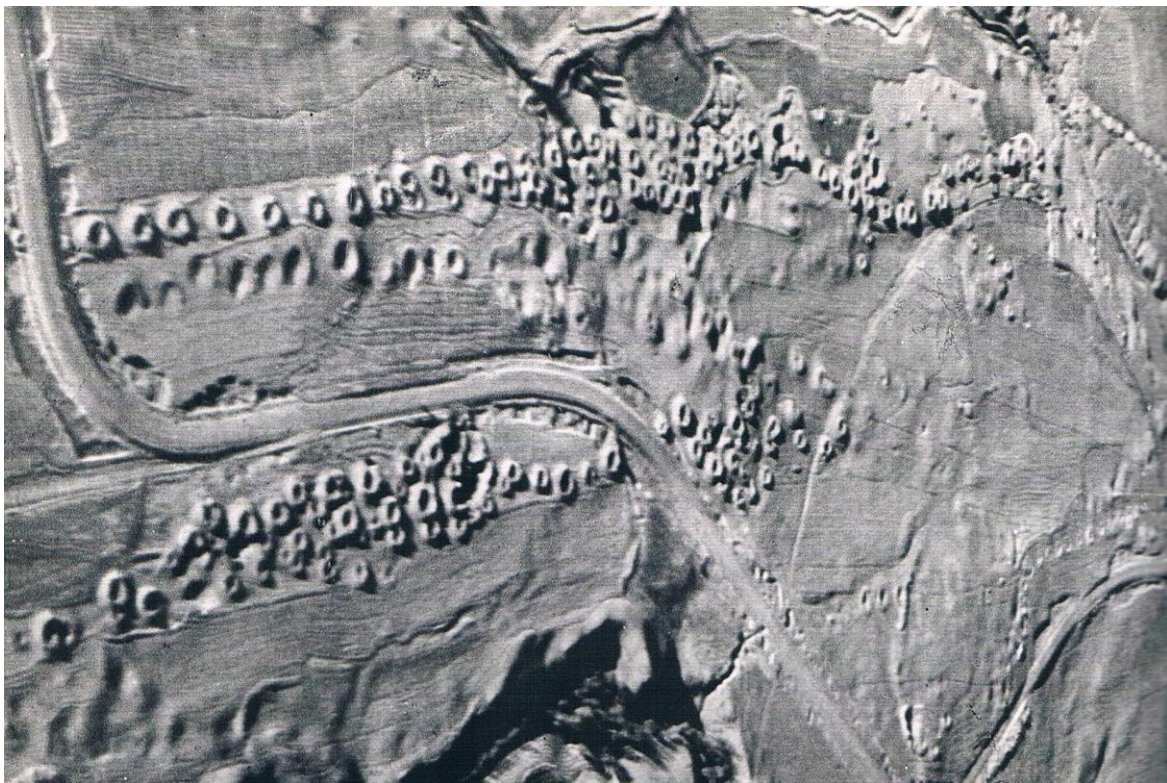
Doc. 11 : Ghanat du Balouchistan vu du ciel. Les trous correspondent aux puits verticaux de perçement et de nettoyage. BALSAN, 1969, p. 138.
