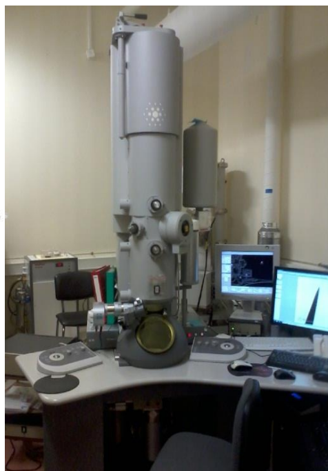
Figures 2.20 : Schéma simplificateur et photo du microscope électronique en transmission utilisé.
