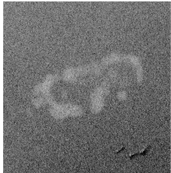
Figure 4.53 : Répartition qualitative du niobium dans la zone représentée sur la figure 4.52.
