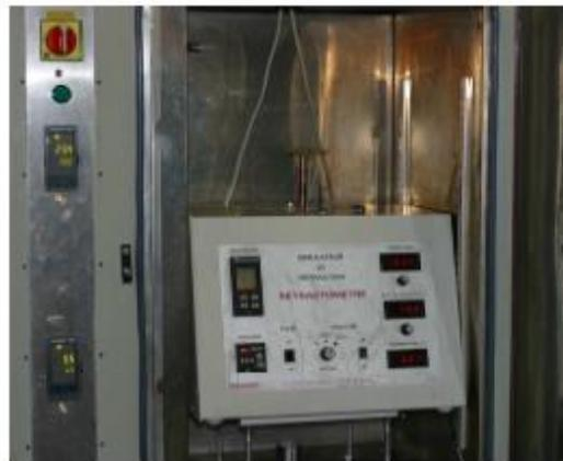
Figure 57. Appareil de traction avec humidité et température contrôlées.
