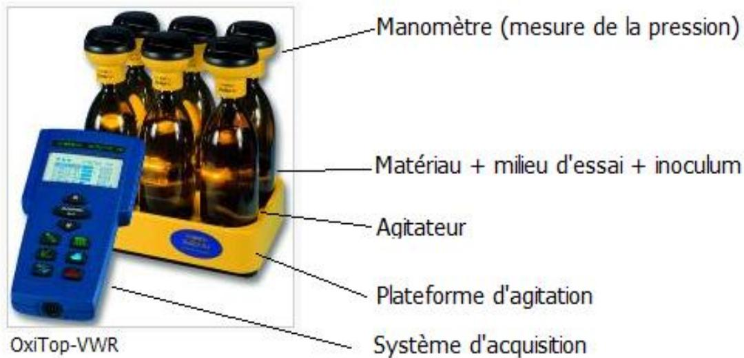
Figure 58. Matériels de suivi de la DBO en milieu liquide
