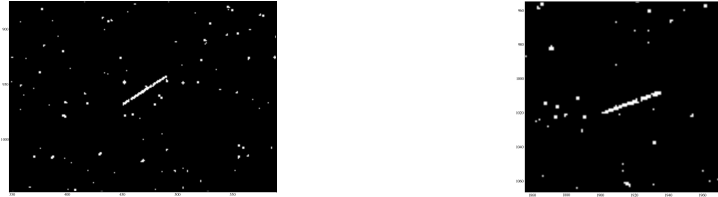
FIGURE 6.18 : Traces imprimées par l'impact d'un cosmique sur plusieurs pixels du détecteur 17187
