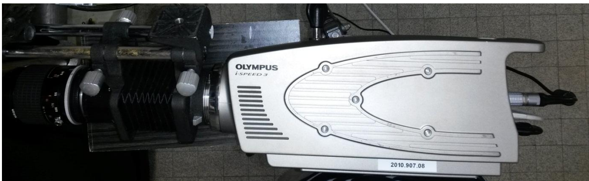
Figure I-9 : Photo de la caméra rapide munie d'un soufflet optique et d'un objectif.
