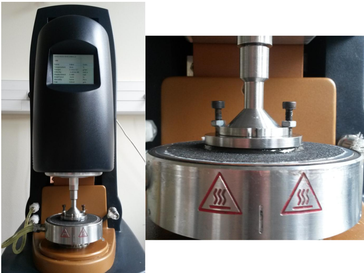
Figure I-2 : Photos du rhéomètre utilisé avec la géométrie cône-plan rugueuse.
