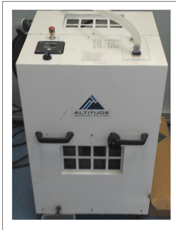
Figure 35 : Hypoxicator (ATS-HP, Pulford Air & Gas Pty Ltd, Australie) utilisé pour produire l'hypoxie normobarique. Celui-ci offre un vaste éventail de FiO_2 grâce à un système de membrane semi-perméable qui filtre l' O_2 de l'air ambiant.
