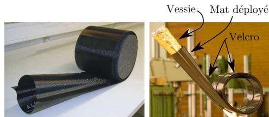
FIGURE 1.12 – Mat gonflable de section en forme de double oméga.
