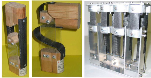
FIGURE 1.28 – Charnière composée de deux rubans de longueur différente.
