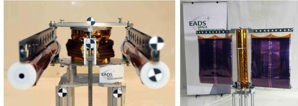
FIGURE 1.11 – Cellules solaires déployées par un mât gonflable.
