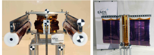
FIGURE 1.11 – Cellules solaires déployées par un mât gonflable.
