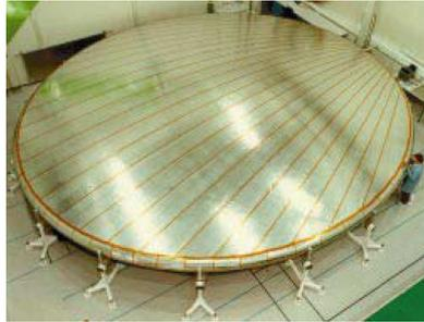
FIGURE 1.5 – ISRS, une antenne réflectrice gonflable.
