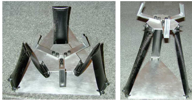
FIGURE 1.21 – Tripode déployé à l'aide de rubans pliés.
