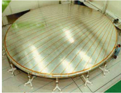
FIGURE 1.5 – ISRS, une antenne réflectrice gonflable.
