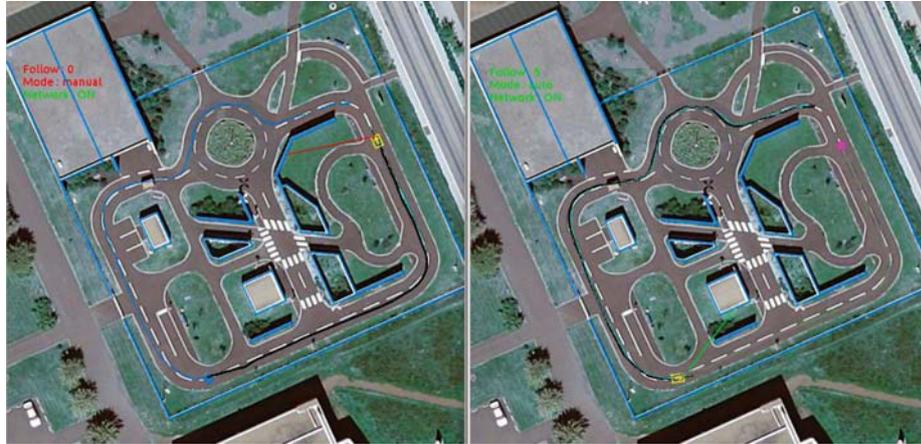
FIGURE VII.28 – Navigation automatique avec récupération de trajectoire : suivi de la trajectoire du vipalab5 par le vipalab3. À gauche, le véhicule vipalab3 (en jaune) avec sa trajectoire estimée (en noir) est visible ainsi qu’une pastille bleue montrant le vipalab5, ce dernier se trouve sur la trajectoire du vipalab3 et la suit. À droite, le véhicule vipalab5 (en jaune) avec sa trajectoire estimée (en noir) est visible ainsi qu’une pastille bleue montrant le vipalab3
