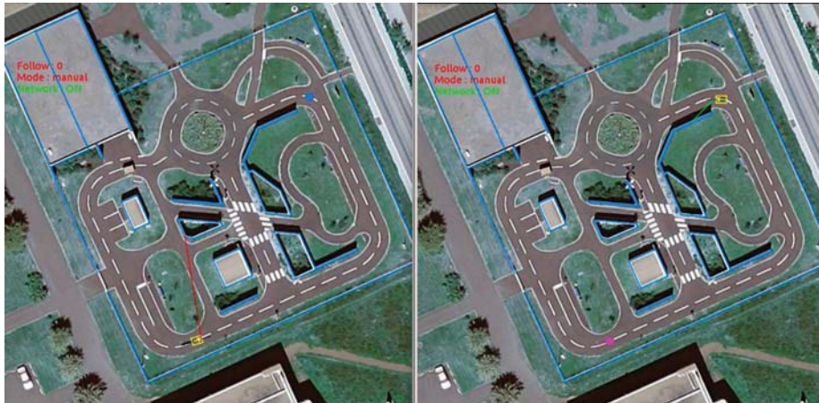
FIGURE VII.27 – Navigation automatique avec récupération de trajectoire : situation de départ. À gauche, le véhicule vipalab3 (en jaune) avec sa trajectoire estimée (en noir) est visible ainsi qu’une pastille bleue montrant le vipalab5. À droite, le véhicule vipalab5 (en jaune) avec sa trajectoire estimée (en noir) est visible ainsi qu’une pastille bleue montrant le vipalab3.
