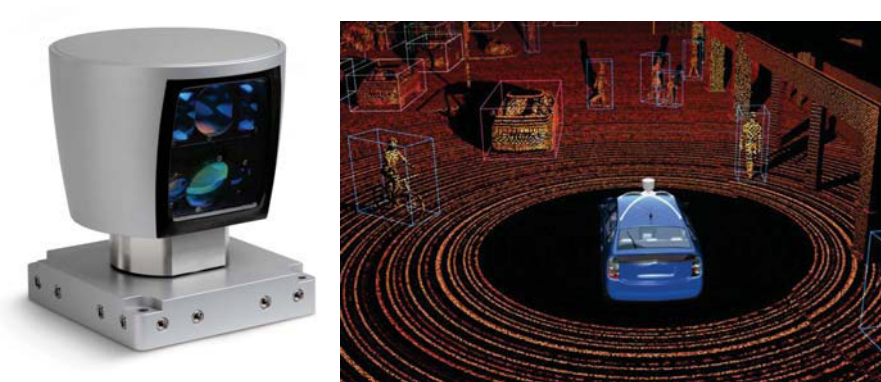
FIGURE III.2 – Vélocity : A gauche une photo du capteur, à droite un exemple d'image 3D fournie par le vélocity
