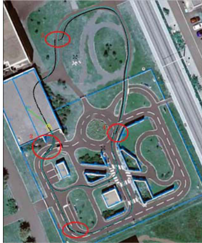
(a) Trajectoire du véhicule. En noir la trajectoire estimée avec notre système, en cyan la trajectoire de référence fournie par le récepteur GPS RTK.
