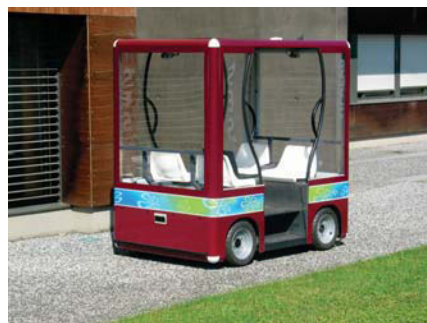
(b) un VipaLab qui peut être équipé avec différents capteurs comme des télémètres, caméra, GPS, etc.
