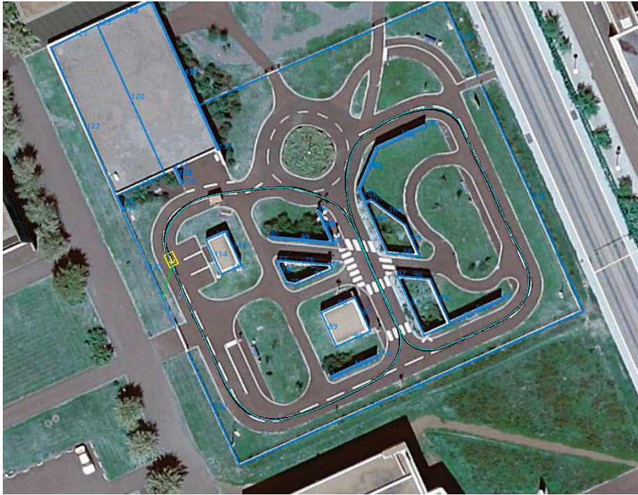
FIGURE VII.17 – Localisation dynamique, estimation de la trajectoire avec un télémètre laser : évolution de l’algorithme. En noir, la trajectoire estimée. En bleu, la trajectoire fournie par le GPS RTK.
