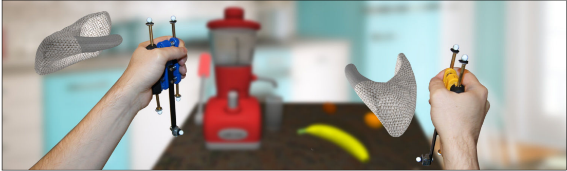
Figure B.12 – Scénario bimanuel faisant usage de la Virtual Mitten. Chaque main tient une interface élastique pour contrôler un modèle de moufle. La force de saisie appliquée sur l'interface est mesurée pour attraper les objets virtuels et générer un retour pseudo-haptique.
