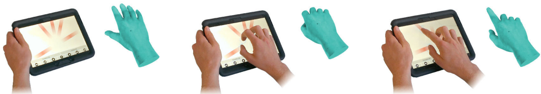
Figure B.2 – Animation d'une main virtuelle avec THING. Notre approche est basée sur une interface tactile qui applique les mouvements de l'utilisateur sur le modèle virtuel. Par exemple, réaliser un mouvement de saisie ou pointer le doigt reflète ce même mouvement sur le modèle de main.
