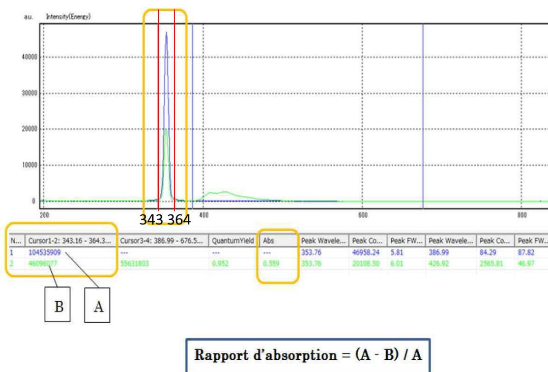
**Figure 51 : Définition du rapport d'absorption permettant de calculer le PLQY<sub>ext</sub> ou taux de conversion du luminophore.**
