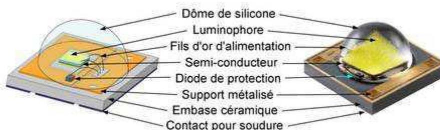
Figure 3 : Schémas de l'architecture d'une LED commerciale <sup>7</sup>.
