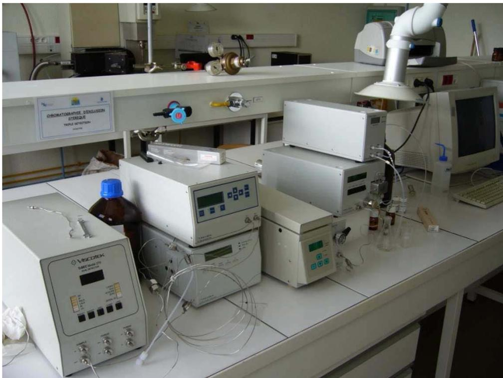
**Figure 50 : Photographie de l'appareil de chromatographie d'exclusion stérique Viscotek.**
