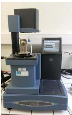
**Figure 49 : Photographie de la DMA Q800 utilisée pour les essais de traction.**
