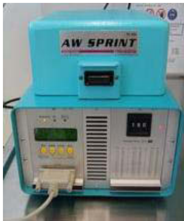
Figure 2.3 Photographie montrant l' a_w -mètre du laboratoire utilisé pour mesurer l' a_w des échantillons de saucissons secs.
