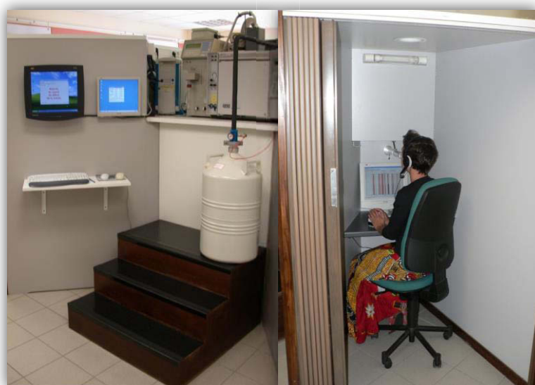
Figure 2.8 Photographies et schéma décrivant le dispositif d'olfactométrie à 8 voies du laboratoire qui a été utilisé pour faire un inventaire exhaustif des composés odorants-actifs piégés dans les échantillons de saucissons secs analysés.
