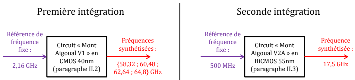
Figure IV.1 Schémas blocs des deux intégrations de l'architecture de synthèse de fréquence
