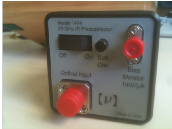
FIGURE 4.8: Photo de la photodiode utilisée comme fréquence NEW FOCUS 141450
