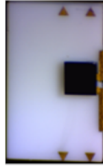
FIGURE 4.1: Photographie de la photodiode 1915DC sur substrat de report céramique
