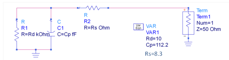
FIGURE 2.4: Modèle électrique de la photodiode issue de [57]
