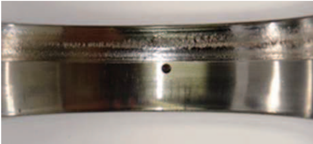
FIGURE 3.11 – Photo de la bague externe du roulement principal à la fin du test d'usure. Un écaillage est présent sur toute la circonférence de la bague.
