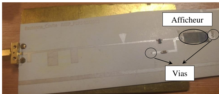
Figure IV. 19. Circuit de conversion RF-DC imprimé sur papier SP3
