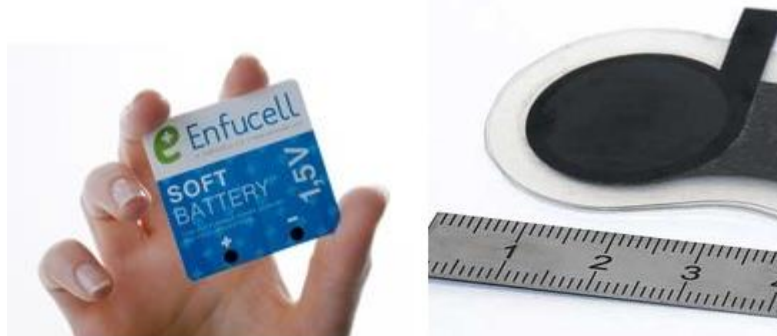
Figure I. 7. Batterie Imprimée a) Enfucell b) ENAS [I.39]
