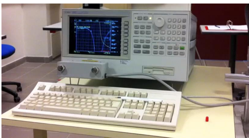
Figure III. 22. Impédance-mètre utilisé pour la caractérisation des afficheurs
