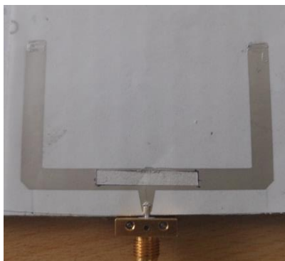
Figure V. 18. Photographie de l'antenne réalisée sur papier, b) Mesure et simulation de l'antenne monopôle avec fente
