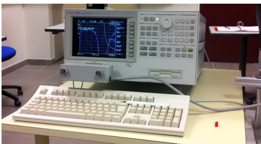
Figure III. 22. Impédance-mètre utilisé pour la caractérisation des afficheurs
