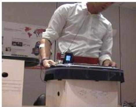
L'aménagement du poste consistait à diminuer la hauteur du plateau et à rehausser le socle afin de les placer à la même hauteur.
