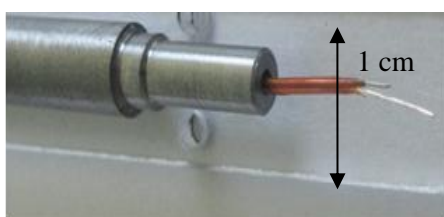
a) Blindage avec un tube magnétique
