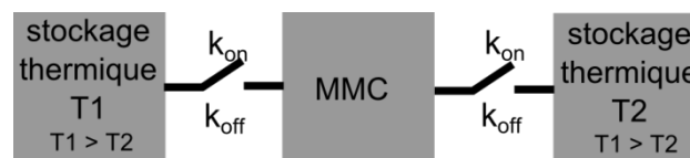
Figure III-15 Contrôle du flux de chaleur avec une diode thermique ou un interrupteur thermique
