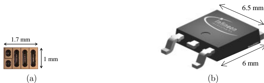
Figure I.21 : Photographies (a) du HEMT GaN EPC2007 [39] 100V Normally-OFF de R_{ON} 30m \Omega et (b) du MOSFET Si IPD33CN10NG [45] 100V Normally-OFF de R_{ON} 33m \Omega . La surface de la puce silicium mise en boîtier est estimée par la Figure I.18 à 5 mm 2
