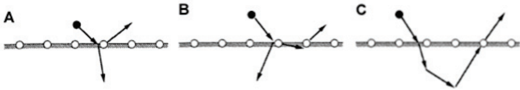
Figure I.19. Mécanismes possibles en régime de collisions simple [45] : (A) le premier atome de la couche est émis directement par l'impact de l'ion incident; (B) à plus hautes énergies, le premier atome se déplace dans le réseau cible et permet l'émission des premiers voisins de l'atome; (C) le premier atome subit plusieurs collisions et est rétrodiffusé vers la surface où l'atome permet l'émission d'un atome de surface
