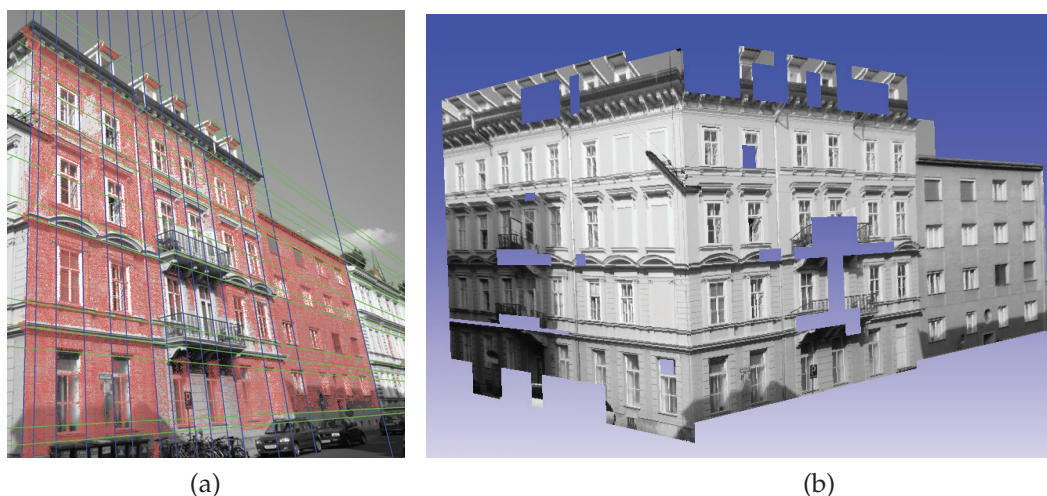
FIGURE 19 – Résultat de la segmentation dans [12]. (a) Intersections des lignes provenant de deux points de fuites distincts, formant des polygone rectangulaires. (b) Les polygones validés forme le modèle polygonal final, et les parties des images correspondantes sont recadrées pour éviter la distorsion de la texture.
