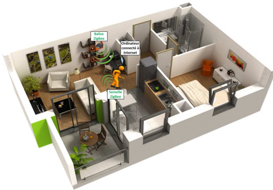
Figure 23. L'architecture générale de la solution.
