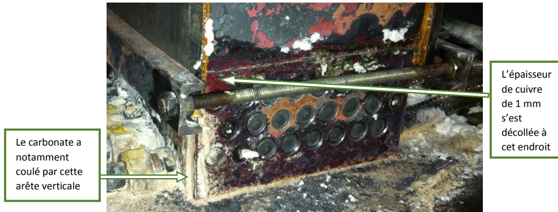
Figure 4.20. Fuite de carbonate de lithium en dehors du banc expérimental
