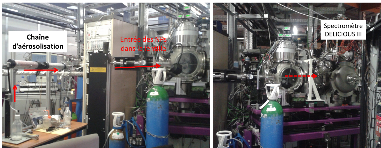
FIGURE 124 : Photographie du montage pour l'étude des NPs en phase gazeuse (Gauche) et du spectromètre DELICIOUS III (Droite) de la ligne de lumière DESIRS.
