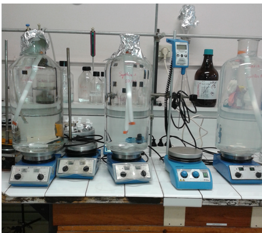
FIGURE 123 : Photographie de l'étape de lavage des membranes de dialyse (Gauche) et de la filtration des solutions de NPs dans les boudins de dialyse (Droite).
