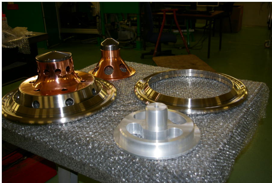
Figure 3.3 – Électrodes du système d'extraction avant montage, de gauche à droite : intermédiaire, première masse et repousseuse
