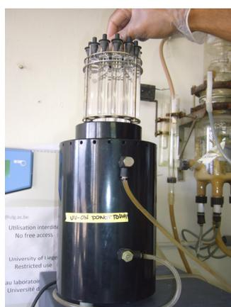
Figure II.17 : vue du digesteur UV 705 chez Metrohm
