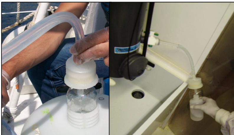
*Figure II.4: Images de filtration sur cartouche Sartorius<sup>TM</sup> (0,2 $\mu\text{m}$ ) en sortie de pompe en Teflon<sup>®</sup> (à gauche) et en sortie de bouteille GO-FLO (à droite).*
