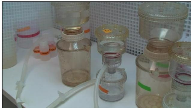
Figure II.5: Image des cocottes de filtration sous hotte à flux laminaire lors du projet CHIPIE
