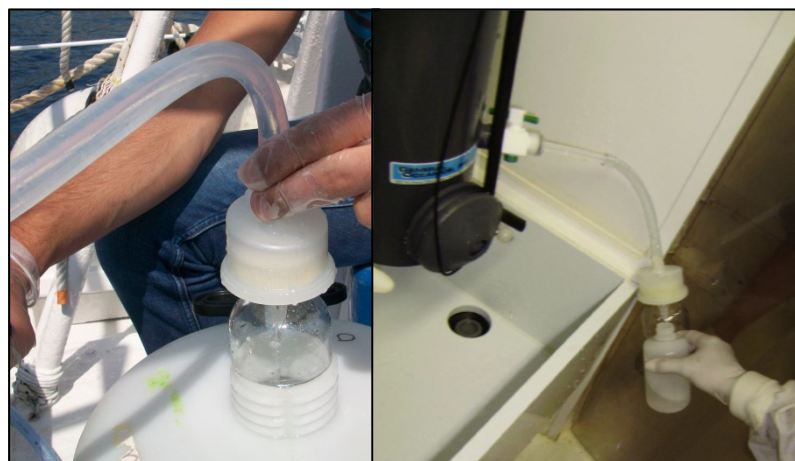
Figure II.4: Images de filtration sur cartouche Sartorius TM (0,2 \mu\text{m} ) en sortie de pompe en Teflon ® (à gauche) et en sortie de bouteille GO-FLO (à droite).
