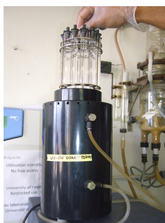
Figure II.17 : vue du digesteur UV 705 chez Metrohm
