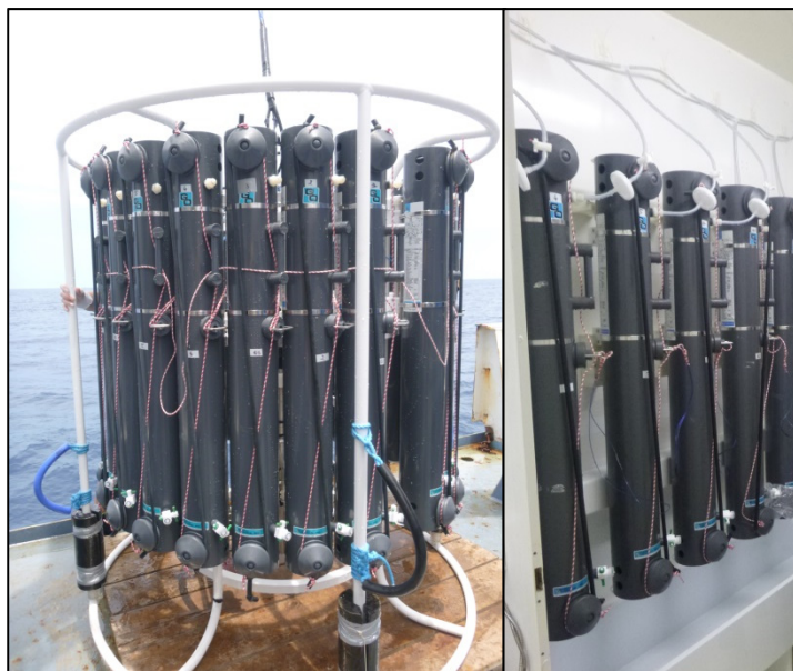
Figure II.3: Images de la rosette "TMC" (gauche) et des bouteilles GO-FLO installées dans le conteneur propre à bord de l'Alatante dans le cadre de la mission OUTPACE
