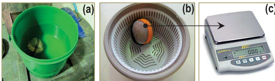
Figure 2-7. (a) Immersion de la passoire sphérique dans l'eau (b) Centrifugation de la passoire (c) Pesée à des intervalles de temps donnés
