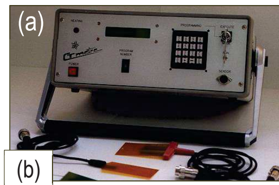
Figure 2-9. Appareil (a) et sondes (b) de mesure de la conductivité thermique (CT-Mètre)
