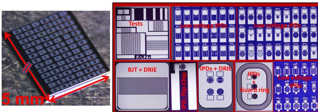
Figure V.12: Images au microscope de quelque détecteurs fabriqués.
